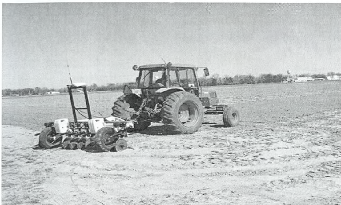
9. Διαδικασία χαρτογράφησης εδάφους με υπολογισμό της Ηλεκτρικής Αγωγιμότητας.
