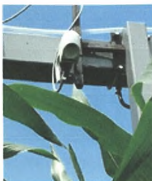
Εικόνα 1.5. Αισθητήρας NDVI που χρησιμοποιείται από το Greenseeker
