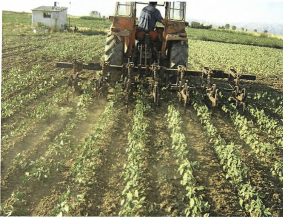
Εικόνα 3. Φρεζοσκαλιστήρι (καταστροφή ζιζανίων ανάμεσα στις σειρές του κενάφ).
