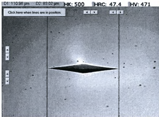
Σχήμα 2.9 : Αποτύπωμα σκληρομέτρησης Κνοορ.
