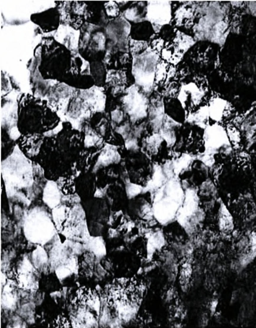
Σχήμα 2.2 Νανοκρυσταλλικός σιδήρου που παράγονται με ενοποίηση, το πλάτος του η φωτογραφία αντιπροσωπεύει 850 nm.
