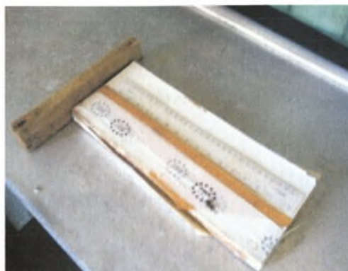
Εικόνα 6: Ιχθυόμετρο για μετρήσεις μήκους
