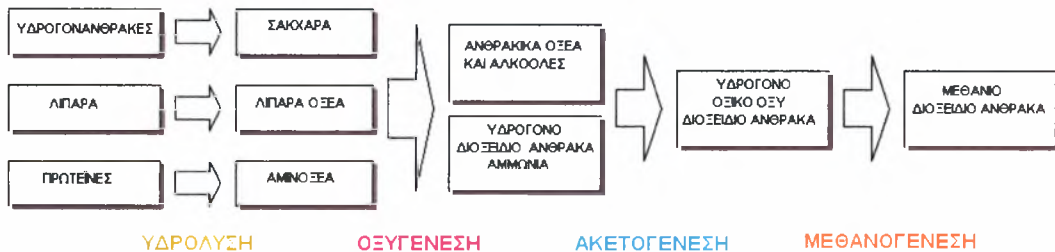
Σχήμα 2-3: Σχηματική απεικόνιση των σταδίων που λαμβάνουν χώρα κατά την αναερόβια επεξεργασία
