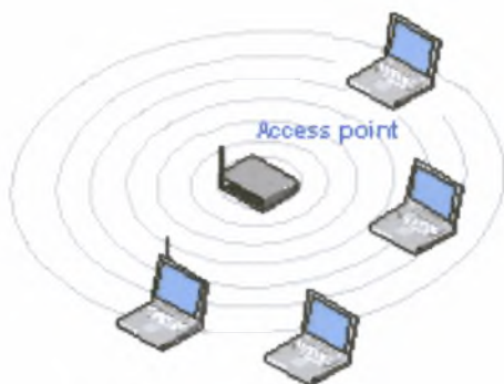
Εικόνα 5.8. Διάταξη με 4 σταθμούς.
