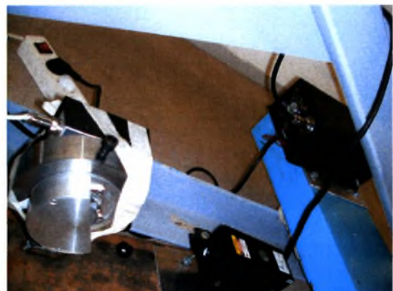
Εικόνα 3.12 Argon ion laser και περιστρεφόμενο πολυγωνικό κάτοπτρο για παραγωγή ομοιόμορφης δέσμης φωτός
