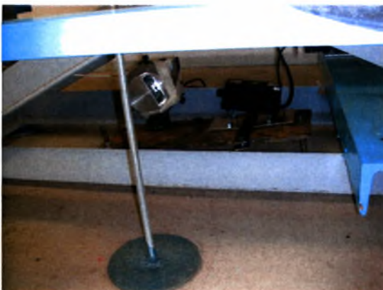
Εικόνα 3.12 Argon ion laser και περιστρεφόμενο πολυγωνικό κάτοπτρο για παραγωγή ομοιόμορφης δέσμης φωτός
