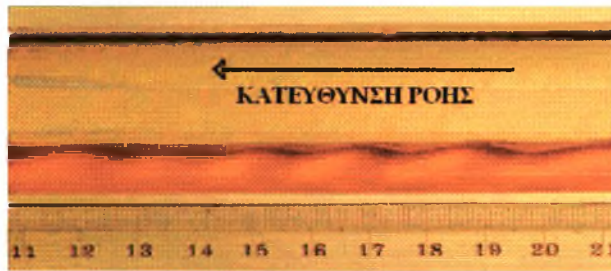
Σχήμα 4-6 Φωτογραφική απεικόνιση κομμάτων 2D για ιξώδες της υγρής φάσης 46 cP
