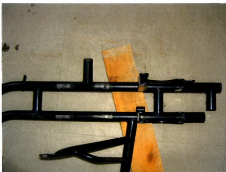
Τα μέρη του σωλήνα με τις περισσότερες ρωγμές και σπασίματα.
