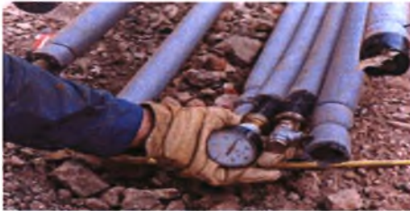
Σχήμα 2.12: Δοκιμή αντοχής γεωεναλλάκτη
