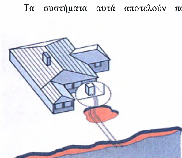
Σχήμα 2.2: Ανοιχτό σύστημα με άντληση νερού από λίμνη
