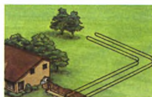
Σχήμα 2.4: Οριζόντιος εναλλάκτης- σωλήνες μια πάνω στην άλλη.
