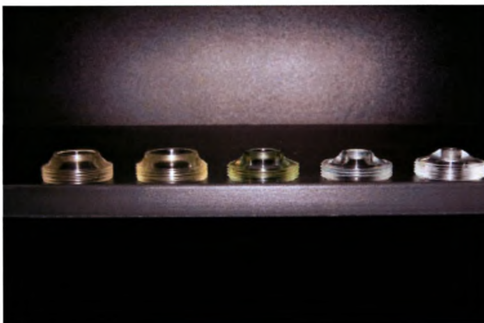
Φωτογραφία 2.10 Κάτοψη ακροφυσίων από αριστερά προς τα δεξιά, D=3.0cm, D=2.5cm, D=2.0cm, D=1.5 cm.
