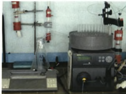
Εικόνα 15. Κλασματοσυλλέκτης και καταγραφέας χρωματογραφίας ιοντοανταλλαγής.
