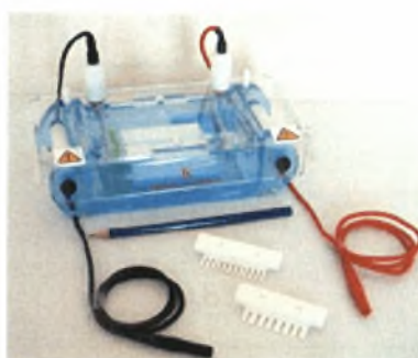
Εικόνα 18. Οριζόντια συσκευή ηλεκτροφόρησης
