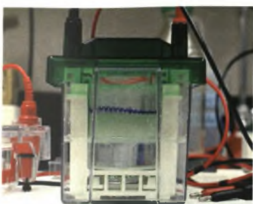
Εικόνα 17. Κάθετη συσκευή ηλεκτροφόρησης
