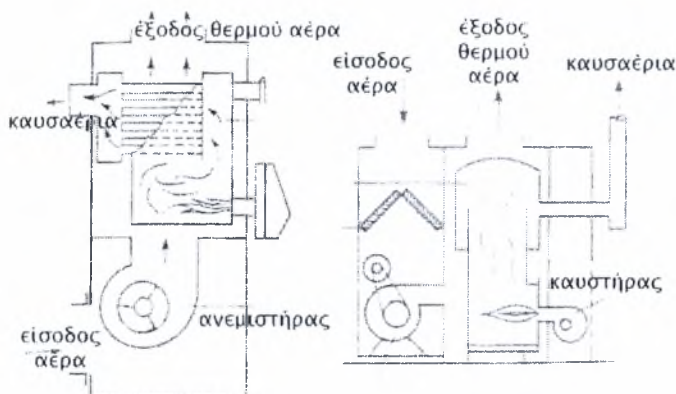
Εικόνα 1 Σχεδιαστικές παραλλαγές αερολεβήτων Ευρωπαϊκού και Αμερικάνικου τύπου.
