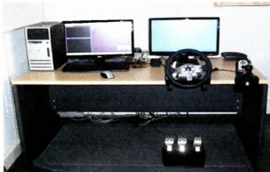
Εικόνα 3.1: Περιφερειακά συστήματα του προσομοιωτή οδήγησης STISIM Drive 100.
