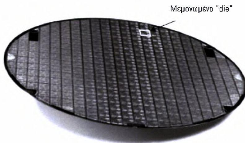
ΣΧΗΜΑ 3.8 Ολοκληρωμένος δίσκος (wafer). Κάθε τετραγωνάκι αποτελεί ένα "die" – σε αυτή την περίπτωση ο επεξεργαστής AMD Duron™.
