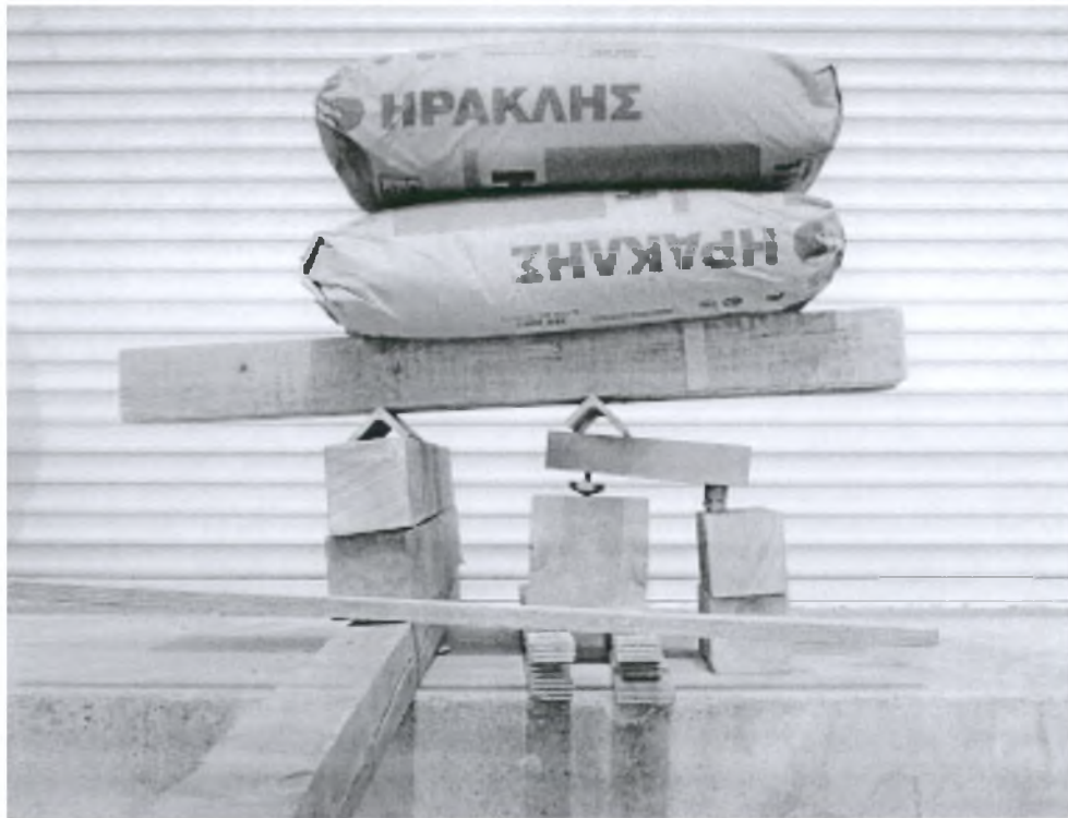
Σχήμα 8.9 Επιβολή φορτίων στο δοκίμιο.
