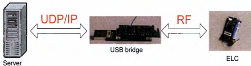
Σχήμα 3-2 Η μετατροπή των πακέτων με το USB bridge
