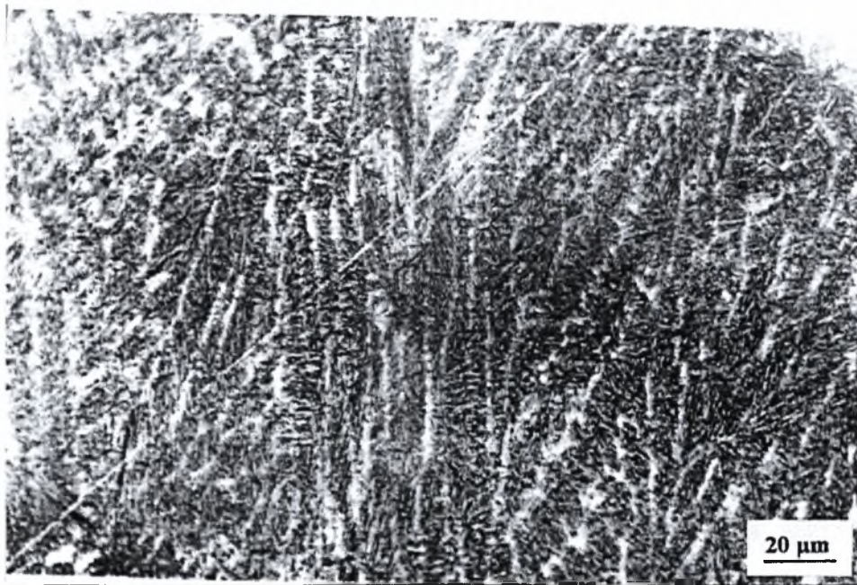
Εικόνα 5.3 Δοκίμιο A3 Διακρίνονται οι δενδρίτες ( πρωτεύοντες βραχίονες) μέσα στους οποίους η δομή είναι μαρτενσιτική
