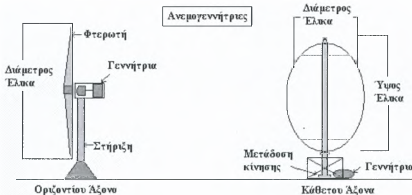
Σχήμα 1.2 Ανεμογεννήτριες οριζόντιου και κατακόρυφου άξονα.
