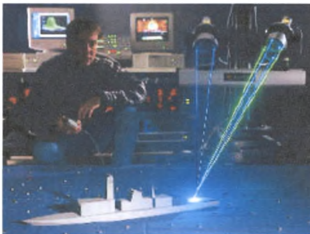
Σχήμα 4-28: Χρήση τρισδιάστατου συστήματος LDA που στην συγκεκριμένη περίπτωση εξετάζει το πεδίο ροής που αναπτύσσεται γύρω από ένα ελικοδρόμιο πλοίου
