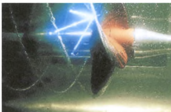
Σχήμα 4-30: Το LDA μπορεί να χρησιμοποιηθεί για την εξέταση προώσεων και δημιουργίας σπηλαιώσεων λόγω της περιστροφικής κίνησης πτερυγίων
