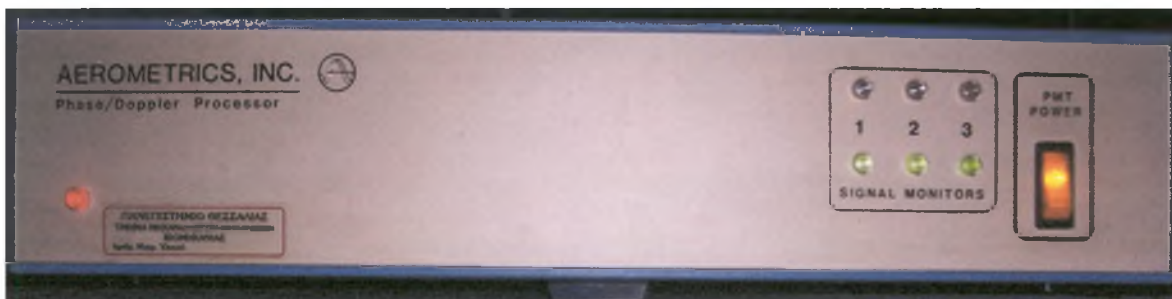
Σχήμα 3-13: Επεξεργαστής σήματος σε χρήση Μοντέλο PDP 3100. Διακρίνονται τα κόκκινα λαμπάκια που δηλώνουν την ύπαρξη κορεσμένου σήματος
