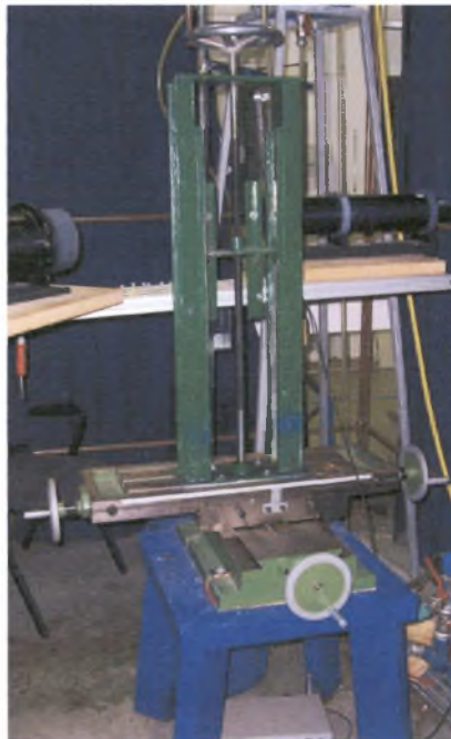
Σχήμα 3-19: Τραπέζι κίνησης σε τρεις διαστάσεις
