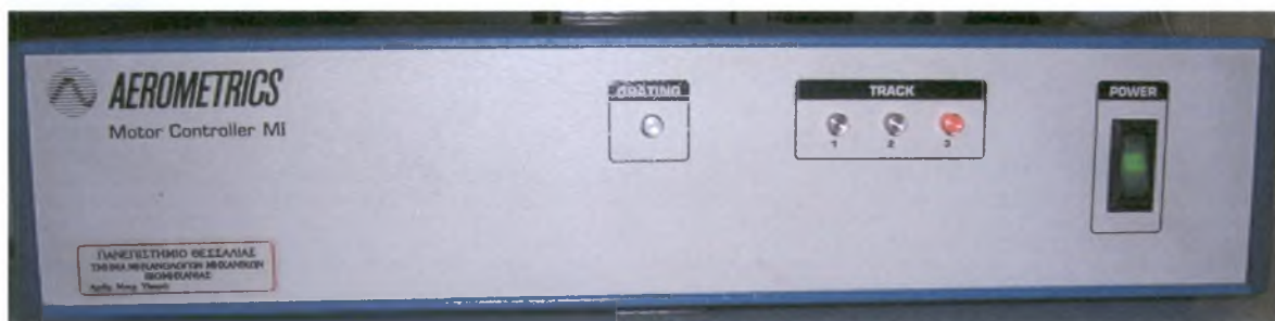
Σχήμα 3-18: Ελεγκτής κινητήρα σε χρήση, μοντέλο MCB – 7100-1. Διακρίνεται το πράσινο λαμπάκι(ο κινητήρας λειτουργεί) και το κόκκινο (δουλεύουμε με το track 3)
