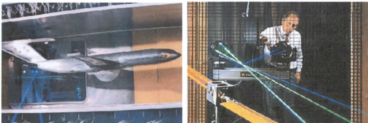
Σχήμα 4-26: α) Μέτρηση τριών στοιχείων ταχύτητας γύρω από ένα μοντέλο προσομοίωσης επιβατικού αεροσκάφους β) Μέτρηση του ρεύματος του αέρα γύρω από στροφέα ελικοπτέρου
