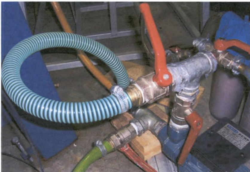
Σχήμα 3-2: Διάταξη bypass και διαφυγής
