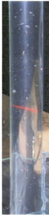
Σχήμα 3-3: Ο κατακόρυφος γυάλινος σωλήνας. Διακρίνονται φυσαλίδες που κυκλοφορούν στη ροή αλλά και η δέσμη Laser που διέρχεται από αυτόν
