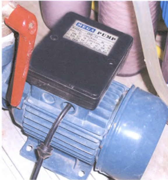
Σχήμα 3-1: Η αντλία του συστήματος, Mega Pump IDB-35
