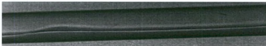
(β) U_{LS}=0,1 m/s και U_{GS}=2,9 m/s - 2D κύματα
