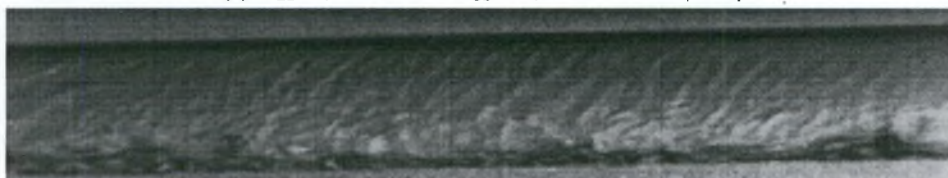
(στ) U_{LS}=0,1 m/s και U_{GS}=26,15 m/s - Δακτυλιοειδής ροή.
