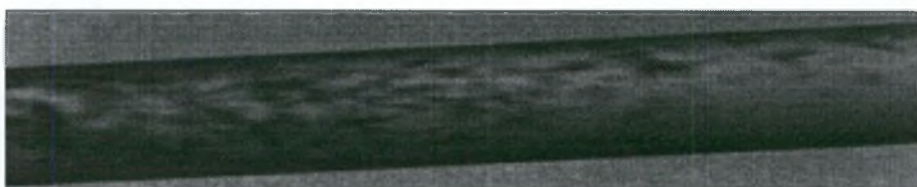
(α) U_{LS}=0,2 m/s και U_{GS}=3,09 m/s Slug
