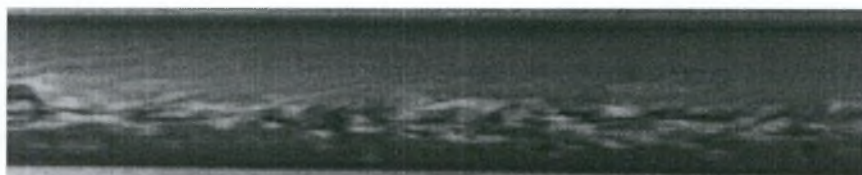
(γ) U_{LS}=0,165 m/s και U_{GS}=5,8 m/s - Μετά το πέρασμα του slug
