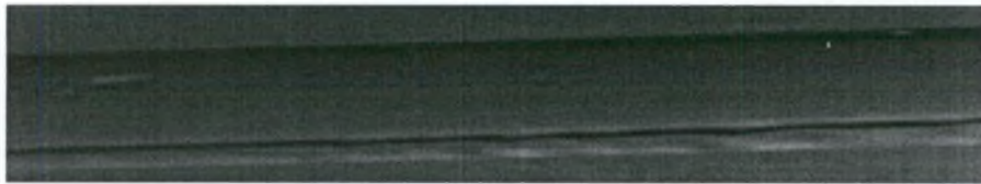
(α) U_{LS}=0,09 m/s και U_{GS}=0 m/s - Διαχωρισμένη ροή με μικρή διαταραχή στη διεπιφάνεια
