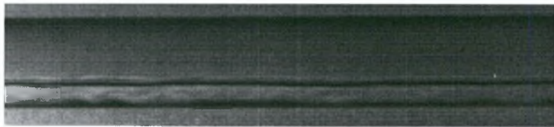
(α) U_{LS}=0,165 m/s και U_{GS}=1,373 m/s- Λεία διαχωρισμένη ροή
