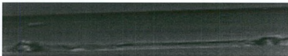
(δ) U_{LS}=0,09 m/s και U_{GS}=9,18 m/s - Ακανόνιστα κύματα μεγάλου πλάτους
