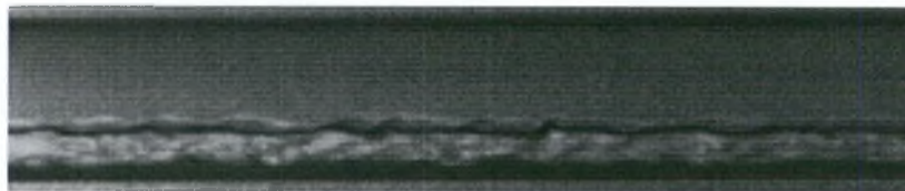
(γ) U_{LS}=0,19 m/s και U_{GS}=10,8 m/s- Ακανόνιστα κύματα
