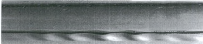
(β) U_{LS}=0,165 m/s και U_{GS}=3,09 m/s- 2D κύματα
