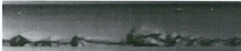
(δ) U_{LS}=0,02 m/s και U_{GS}=10,6 m/s- Κ-Η κύματα
