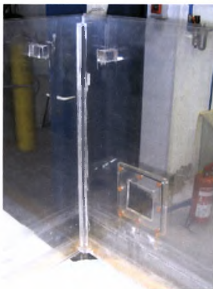
Σχήμα 4.2 Ράβδος και κύβοι Plexiglas για την καλύτερη στήριξη και στεγανοποίηση του θαλάμου.
