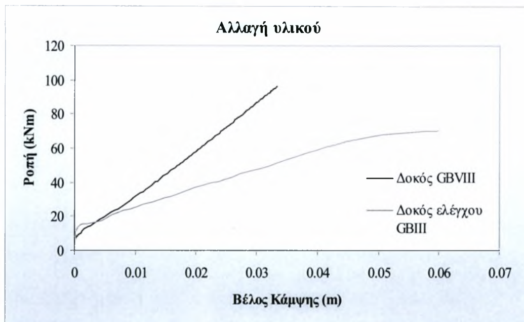
Σχήμα 5.4.2.3 : Διάγραμμα βέλους κάμψης – ροπής δοκών GBIII και GBVIII
