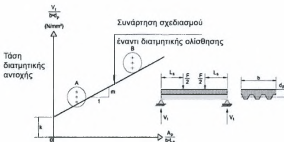
Σχήμα 6.2.2 – Διάγραμμα μεθόδου m - k κατά EC4
