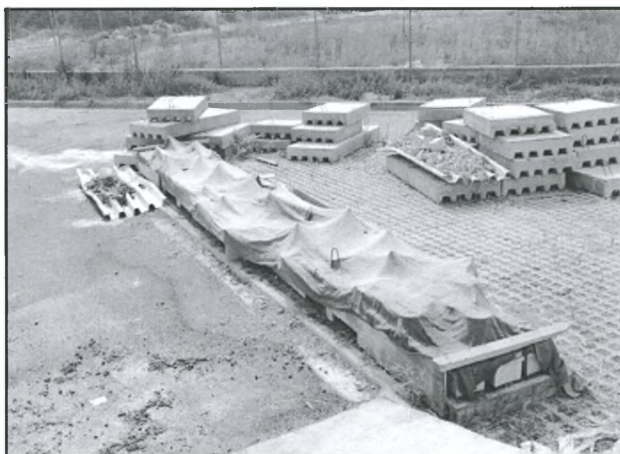
Σχήμα 3.2.1 Συντήρηση δοκιμών πλακών.
