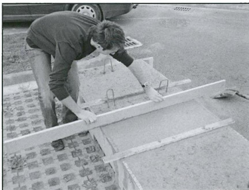
Σχήμα 3.1.4 Διαμόρφωση της επιπεδότητας της πάνω επιφάνειας του δοκιμίου.
