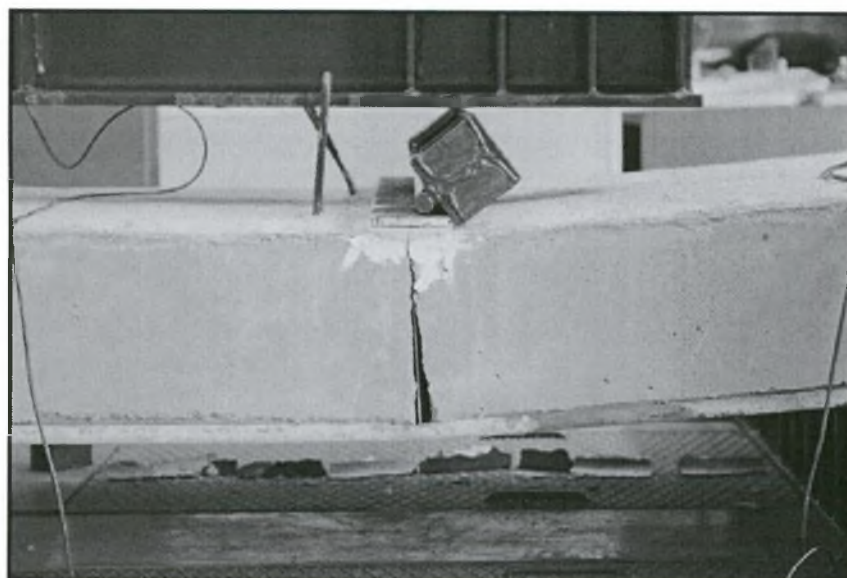
Σχήμα 5.3.3 - Τελική κατάσταση της πλάκας στις στηρίξεις, μεγάλη σχετική ολίσθηση
