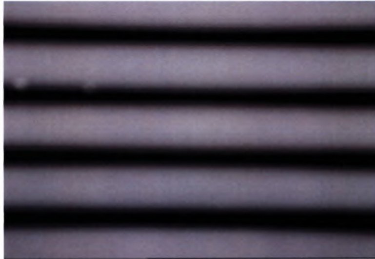
Σχήμα 3.8: . Μία χαρακτηριστική εικόνα φθορισμού στη περίπτωση της ροής υγρού υμένα πάνω από τοίχωμα ημιτονοειδούς μορφής .
