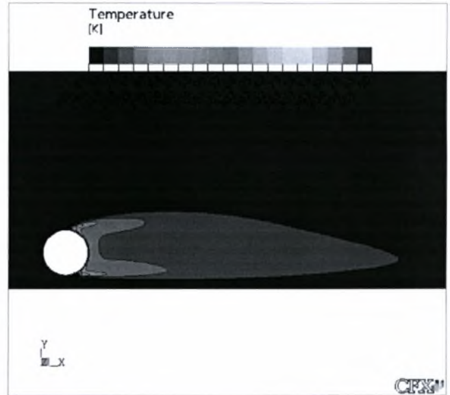
5.270 Ισοϋψείς καμπύλες θερμοκρασίας για H/D=4,0 & D=50\text{mm}
