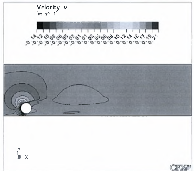
5.172 Ισοϋψείς καμπύλες μέσωσν ταχυτήτων στη Υ διεύθυνση για H/D=4.1 & D=50\text{mm}
