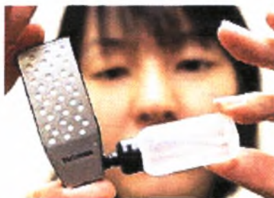
Σχήμα 2.10: Κυψελίδα καυσίμου DMFC της Toshiba. Με 2ml μεθανόλης μπορεί να τροφοδοτήσει ένα MP3 player για περίπου 20 ώρες [ http 13 ].
