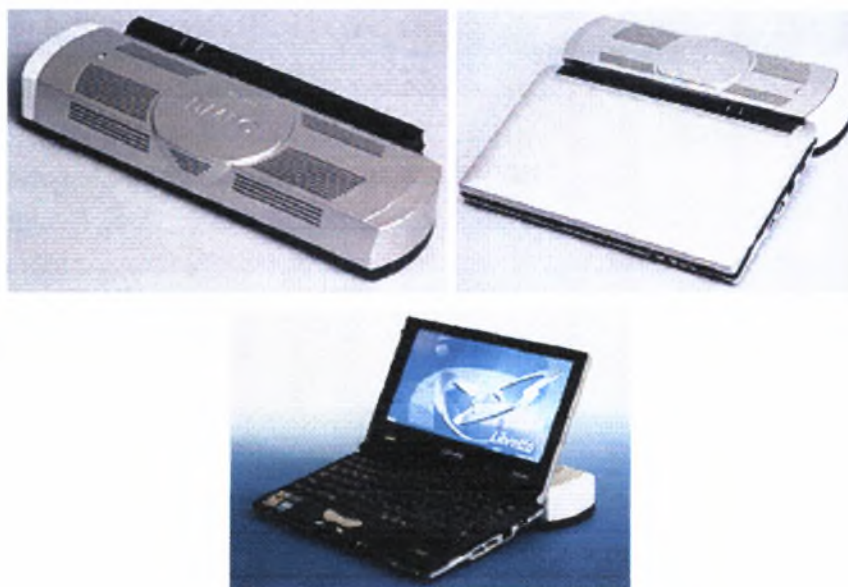
Σχήμα 2.9: Φορητός υπολογιστής της Toshiba με χρήση κυψέλης καυσίμου DMFC [ http 13 ]
