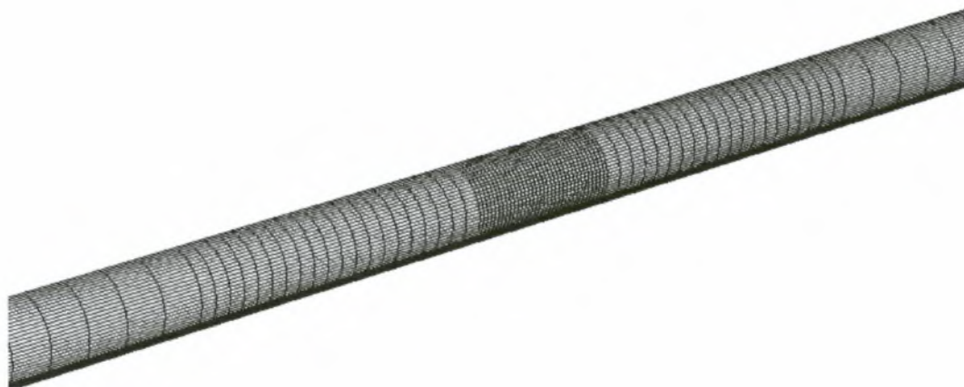
Σχήμα 3.3.1 Μοντέλο πεπερασμένων στοιχείων για τα κελύφη των πειραμάτων TestD2-37 και TestD3-40
