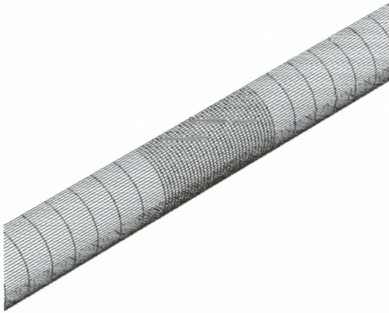
Σχήμα 3.2.3 Μοντέλο πεπερασμένων στοιχείων για τα κελύφη των πειραμάτων TestD1-32, TestD1-36, TestD1-35 και Test1CDB
