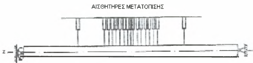
Σχήμα 2.2.2 Πειραματική διάταξη για τον υπολογισμό της καμπυλότητας και της γεωμετρίας των κελυφών πριν και μετά την διείσδυση
