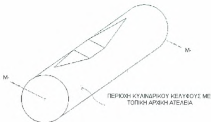
Σχήμα 4.1.1 Περιοχή κυλινδρικού κελύφους με τοπική αρχική ατέλεια και φορά εφαρμοζόμενου καμπτικού φορτίου
