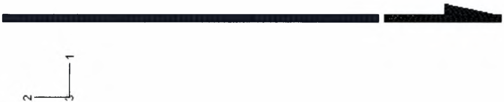
Σχήμα 3.3 λεπτομέρεια περιοχής των προς σύνδεση άκρων των αγωγών (πριν το πρώτο βήμα της ανάλυσης)
