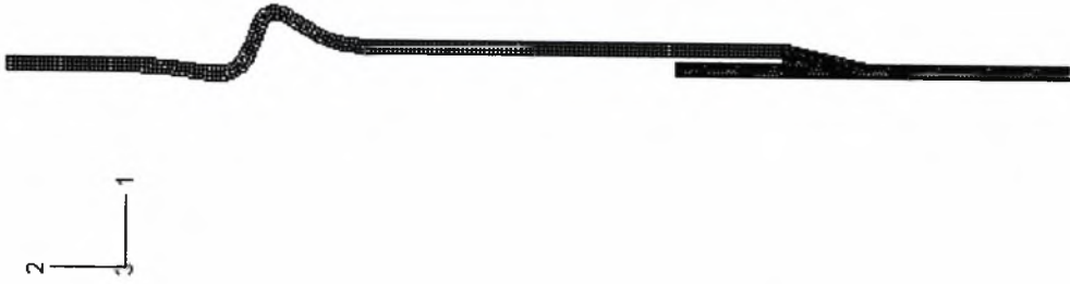
Σχήμα 3.43 περιοχή σύνδεσης παραμορφωμένου κελύφους με \frac{L_b}{t} = 8 , \frac{e}{t} = 1.47 και
