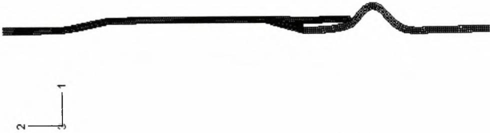
Σχήμα 3.53 περιοχή σύνδεσης παραμορφωμένου κελύφους με \frac{L_b}{t}=8 , \frac{e}{t}=1.62 και
