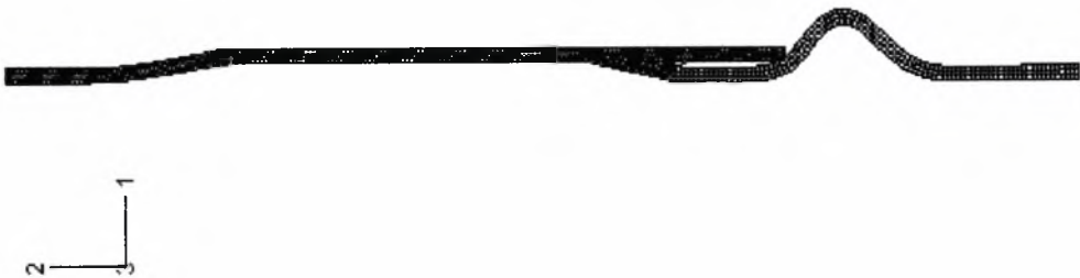
Σχήμα 3.46 περιοχή σύνδεσης παραμορφωμένου κελύφους με \frac{L_b}{t}=8 , \frac{e}{t}=1.31 και
