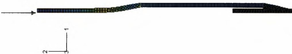
Σχήμα 3.6 λεπτομέρεια περιοχής σύνδεσης των αγωγών (μετά το τρίτο βήμα της ανάλυσης)
