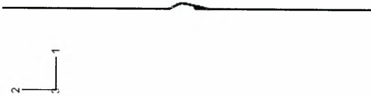
Σχήμα 2.4α μορφή των υπόψη συνδέσεων αγωγών (με D=915mm , t=10mm ) υπό αξονική φόρτιση.
