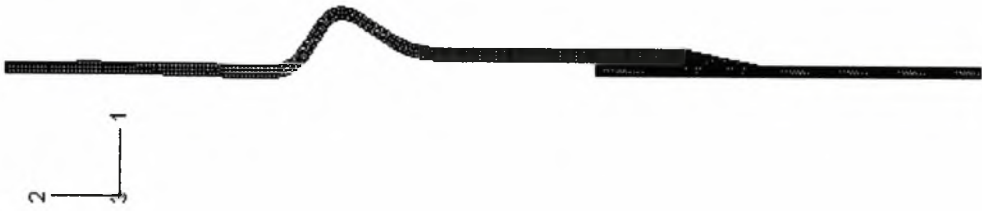
Σχήμα 3.88 λεπτομέρεια περιοχής σύνδεσης παραμορφωμένου κελύφους με L_s/t = 31.66 (Μοντέλο I)
