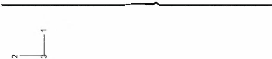
Σχήμα 3.12α παραμορφωμένο κέλυφος με \frac{D}{t} = 95
