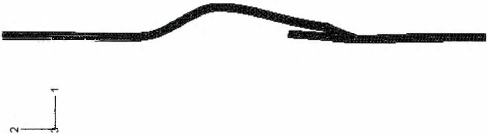
Σχήμα 2.4β λεπτομέρεια σύνδεσης παραμορφωμένων κελυφών με D=915mm , t=10mm , υπό αξονική φόρτιση.
