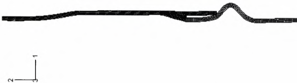
Σχήμα 3.54 περιοχή σύνδεσης παραμορφωμένου κελύφους με \frac{L_b}{t} = 12 , \frac{e}{t} = 1.62 και
