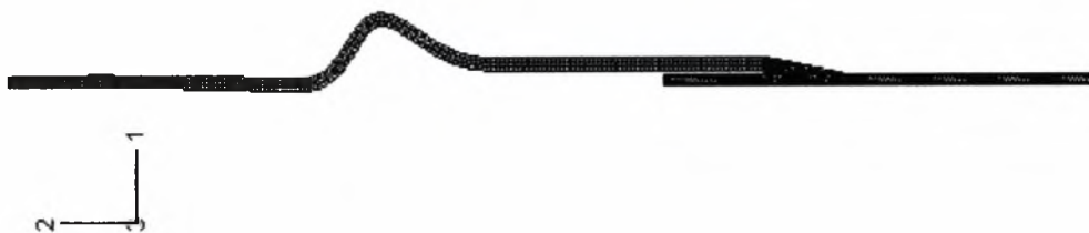
Σχήμα 4.3 λεπτομέρεια περιοχής σύνδεσης παραμορφωμένου κελύφους, λαμβάνοντας υπόψη την κατεργασία διαμόρφωσης της «καμπάνας» κατά την ανάλυση.
