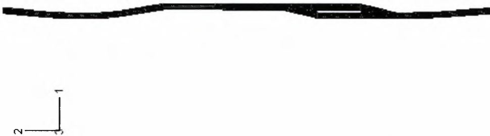
Σχήμα 3.15β περιοχή σύνδεσης παραμορφωμένου κελύφους με \frac{D}{t} = 95
