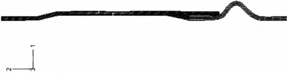
Σχήμα 3.45 περιοχή σύνδεσης παραμορφωμένου κελύφους με \frac{L_b}{t}=5 , \frac{e}{t}=1.31 και
