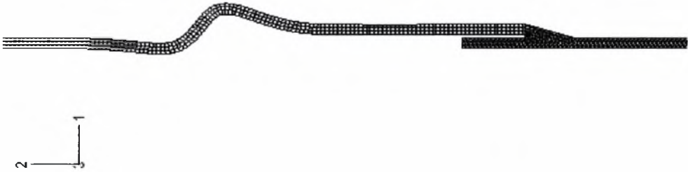
Σχήμα 3.39 περιοχή σύνδεσης παραμορφωμένου κελύφους με \frac{L_b}{t} = 5 , \frac{e}{t} = 1.3 και
