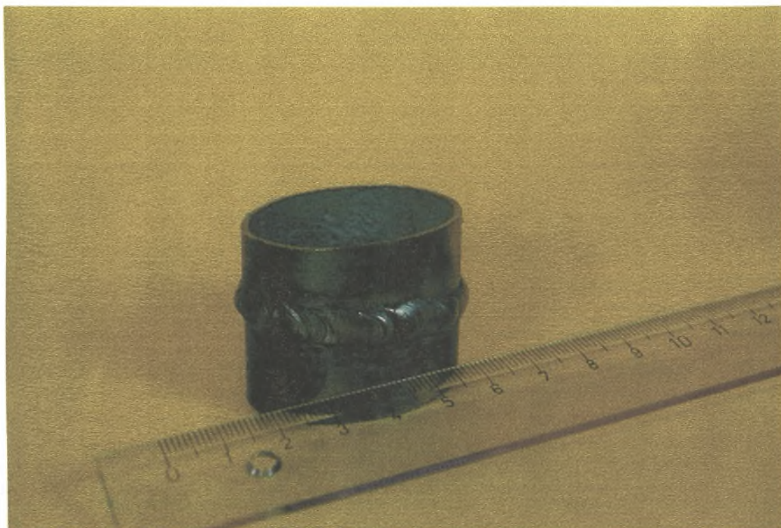
Φώτο 1. Φωτογραφία του αγωγού με την συγκόλληση και την ρωγμή
