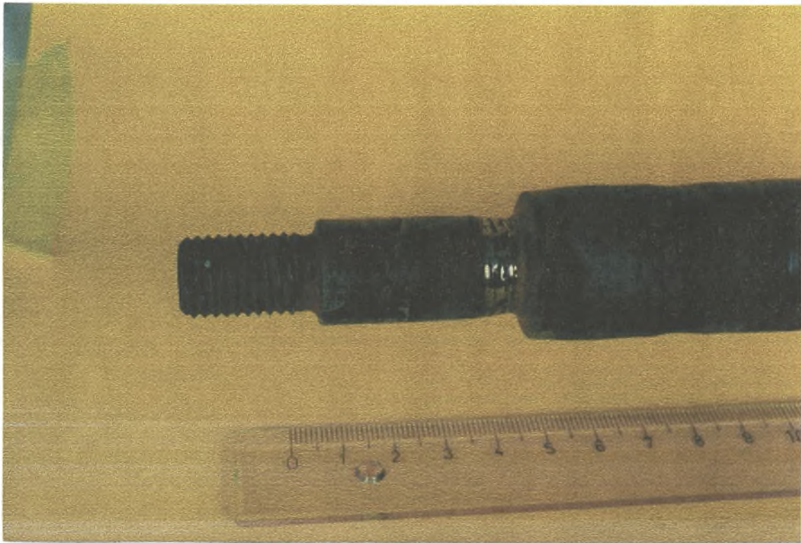
Φώτο 3. Φωτογραφία του άξονα μετάδοσης κίνησης με την περιφερειακή ρωγμή
