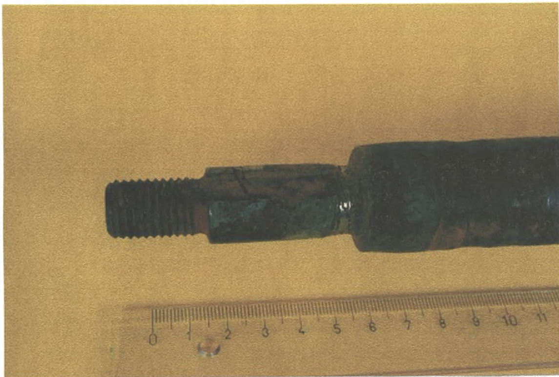
Φώτο 2. Φωτογραφία του άξονα μετάδοσης κίνησης με την περιφερειακή ρωγμή στον σφηναύλακα
