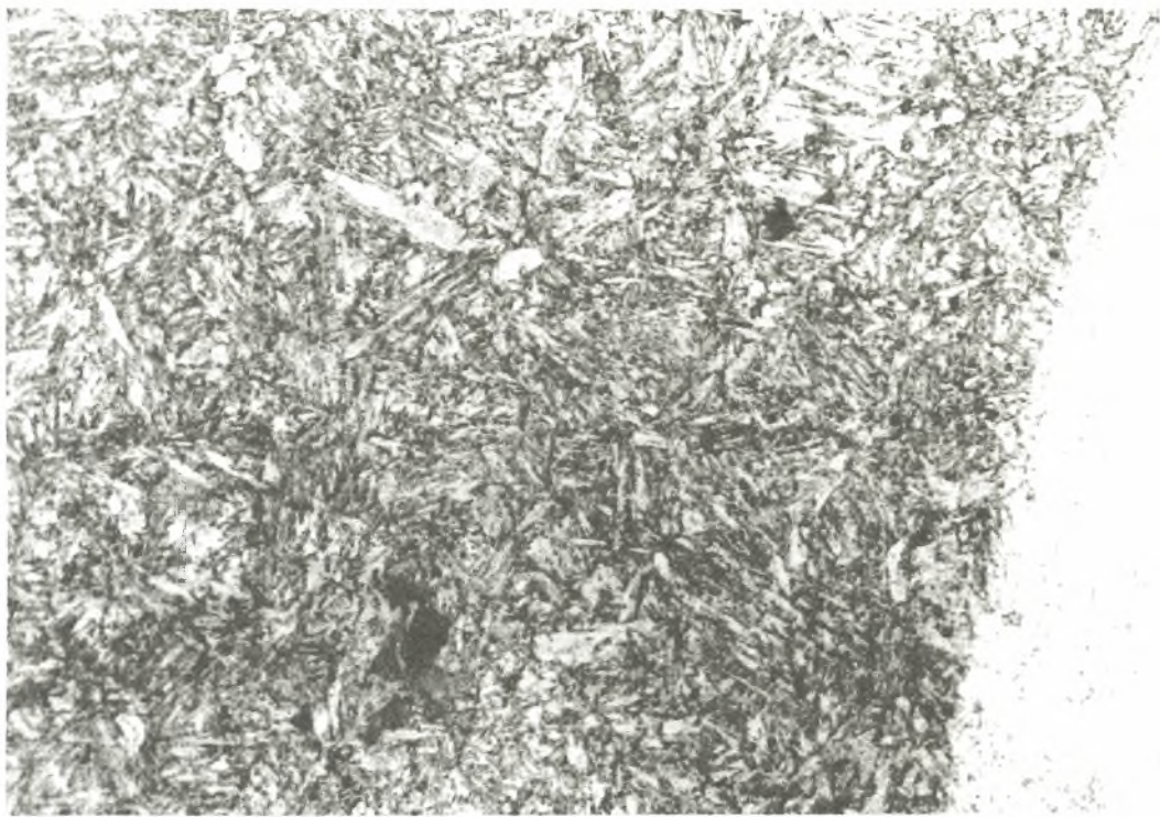
Φώτο 4. (x 1000) Δομή του χάλυβα του ζυγκιού 1. Δοκίμιο 2.
