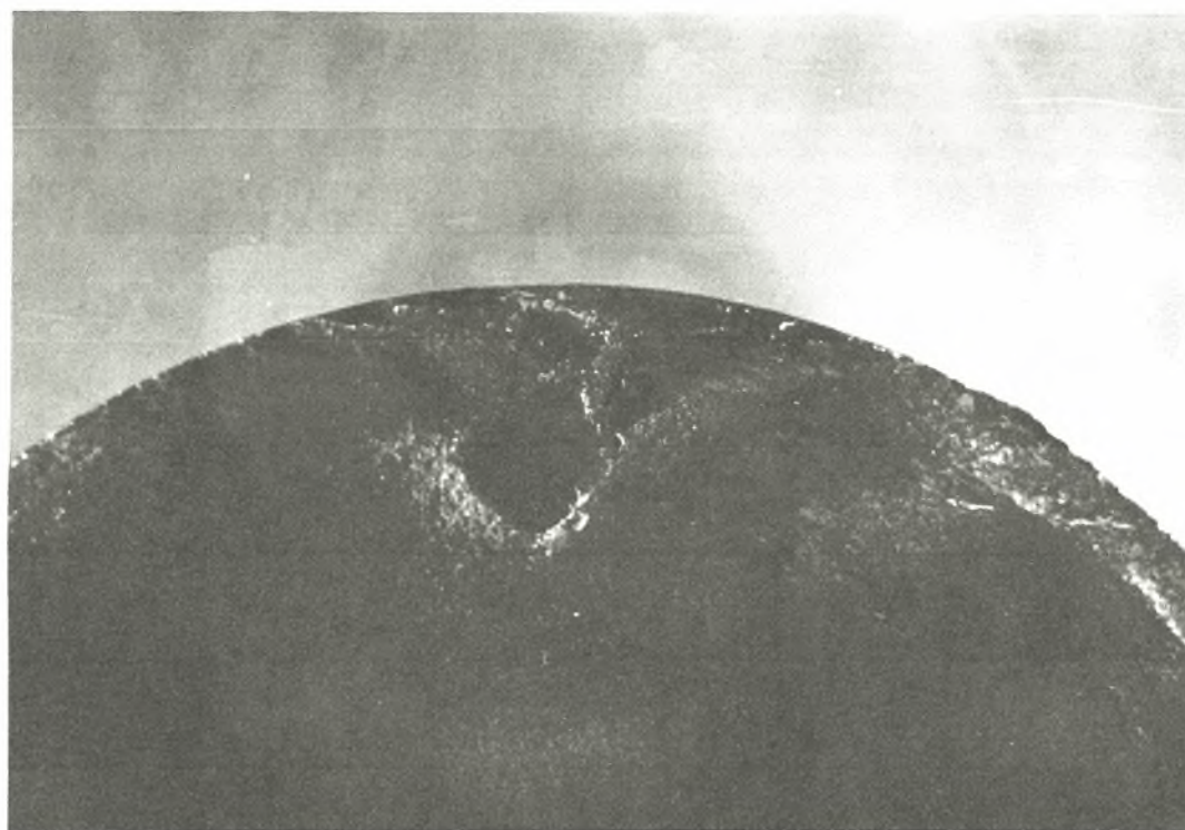
Φώτο 2. Στερεομικροσκοπία του άξονα της φτερωτής της αντλίας με την έναρξη της ρωγμής
