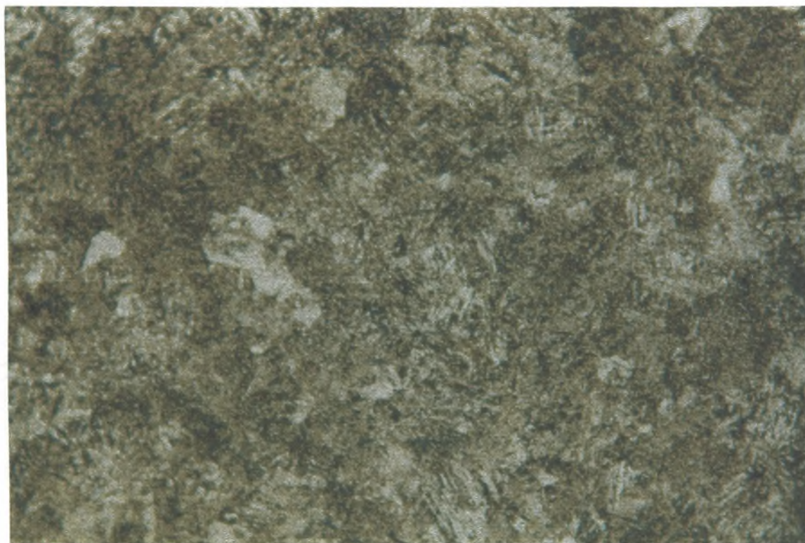
Φώτο 5. (x 200) Δομή του χάλυβα του άξονα της φτερωτής της αντλίας. Δοκίμιο 2.
