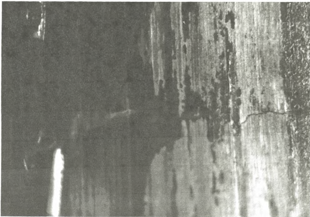
Φώτο 6 . Στερεομικροσκοπία του εσωτερικού του κουζινέτου με την ρωγμή
