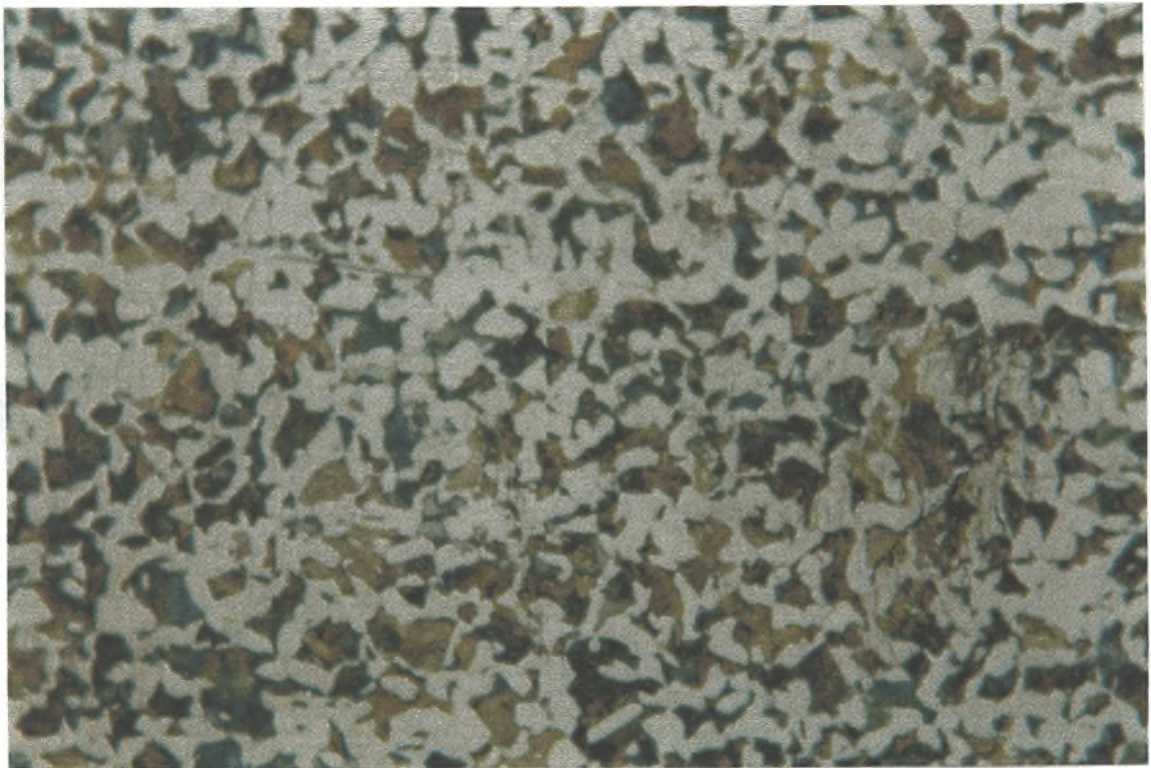
Φώτο 8. (x 200 ) Δομή του χάλυβα του άξονα PDC αναμείκτη . Δοκίμιο 2.
