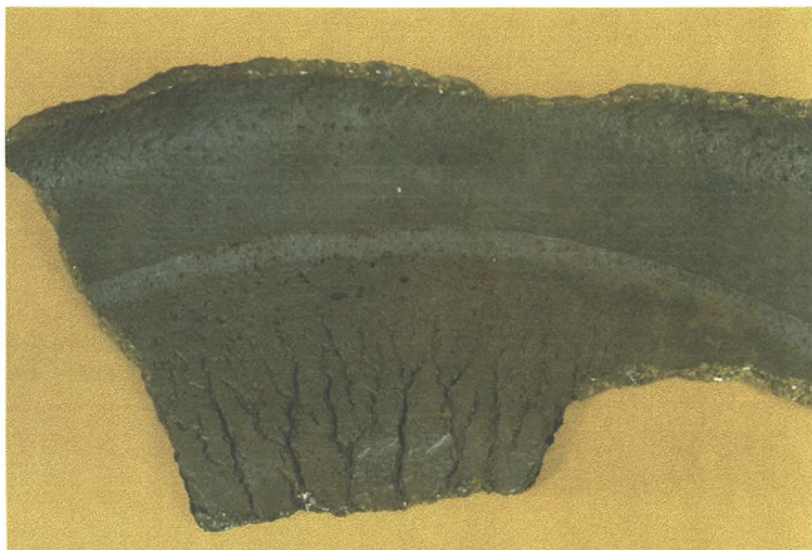
Φώτο 1 . Φωτογραφία του κελύφους της αντλίας με τα αυλάκια και τους πόρους
