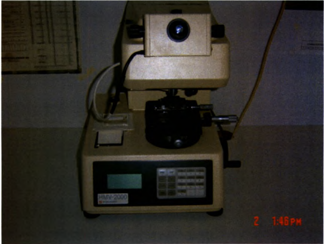
Σχ.2.28 Μικροσκληρόμετρο τύπου HMV- 2000 SMIMADJU.
