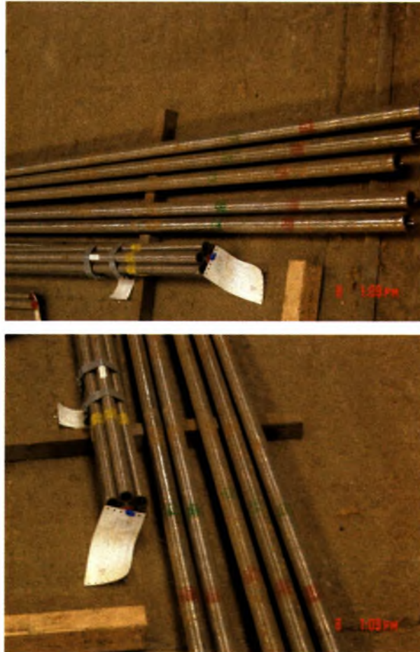
Σχ. 1 Αυλοί υπέρθερμου ατμού: 15Mo3( χρώμα πράσινο-κόκκινο), 13CrMo44(χρώμα κίτρινο-ασημί)
