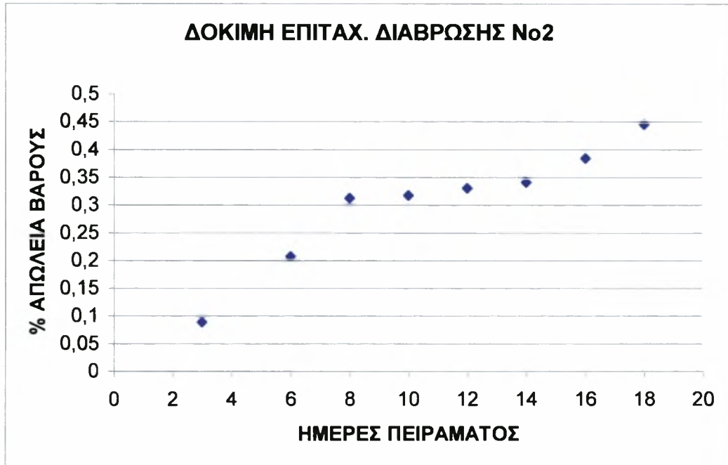
Σχήμα 5.2 Μεταβολή βάρους των δοκιμίων στη δοκιμή Νο 2
