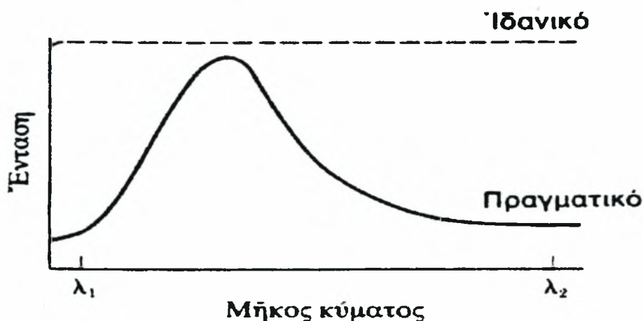
ΣΧΗΜΑ 2.6 : Ένταση της πηγής ως προς το μήκος κύματος σε δεδομένη θερμοκρασία
