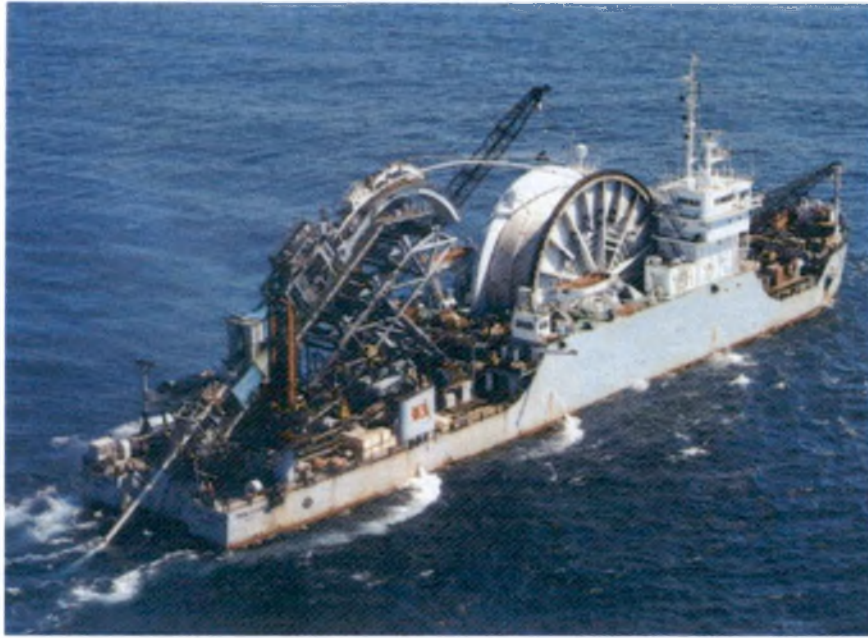
ΣΧΗΜΑ 1-4: Μέθοδος reel-pipe laying (Veldman and Lagers,1997)
