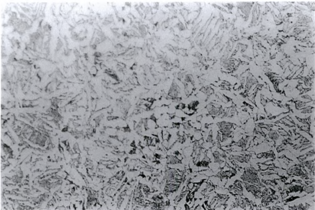
Εικόνα 5.22. Κοινός χάλυβας. Μικροδομή : φερριτοπερλιτική. Nital 2%, 500×
