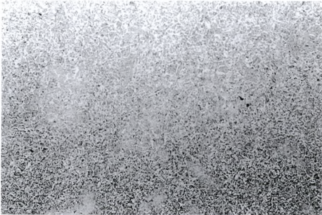
Εικόνα 5.4. Κοινός χάλυβας. Μικροδομή σχετικά μακριά από τη διεπιφάνεια : φερριτοπερλιτική. Nital 2%, 100×
