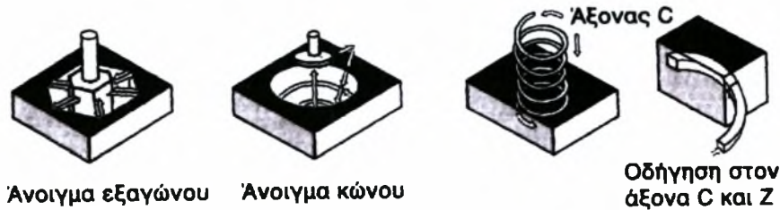
Εικόνα Νο 2.11 : Άνοιγματα που προκύπτουν από τη βύθιση με ηλεκτροδιάβρωση και πλανητική κίνηση του εργαλείου
