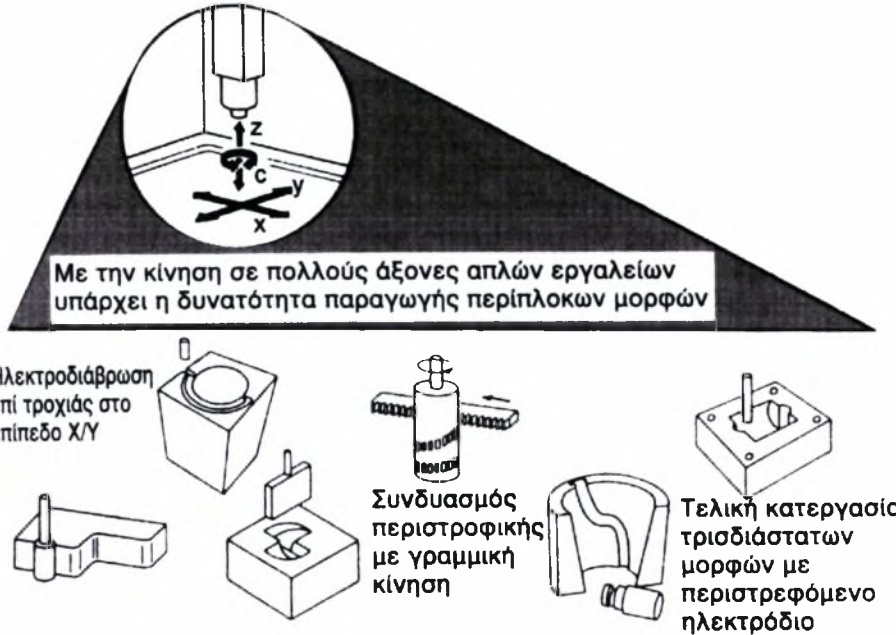
Εικόνα Νο 2.9 : Βύθιση με ηλεκτροδιάβρωση και οδήγηση τροχιάς
