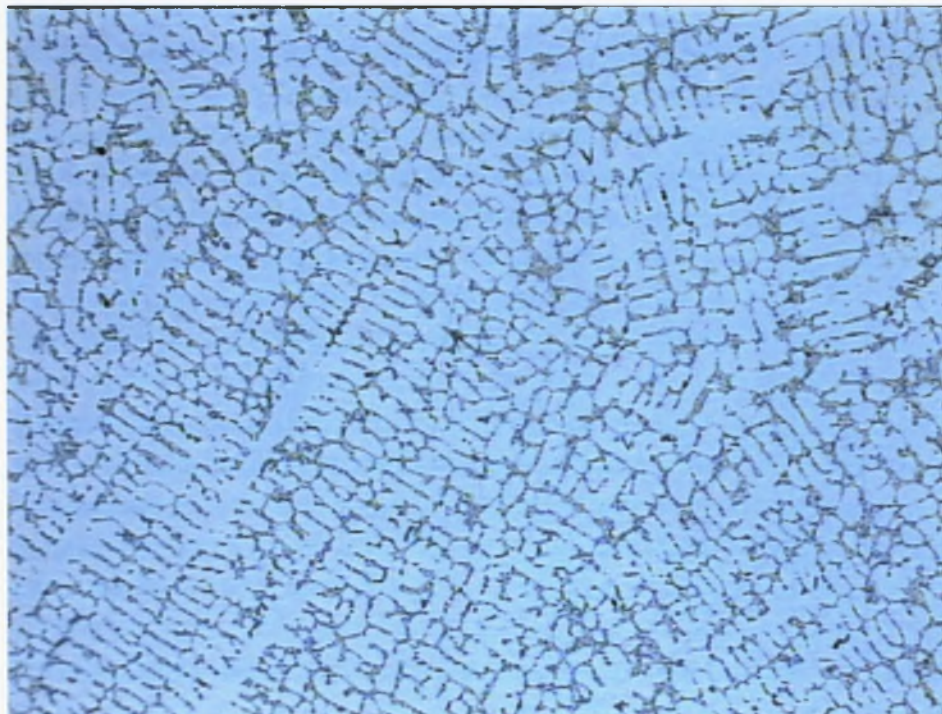
Εικόνα 5.3.1(α) Μικροδομή κράματος αλουμινίου AlSi7Mg [x50]
