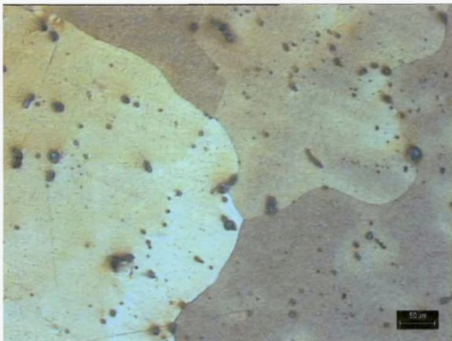
Εικόνα 5.3.8(β) Μικροδομή κράματος χαλκού CuZn33Pb [x200]
