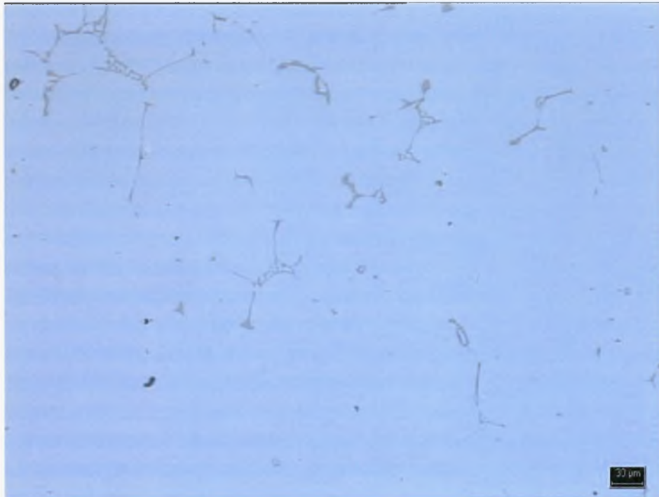
Εικόνα 5.3.5(α) Μικροδομή κράματος αλουμινίου AlCu4Ti [x200]
