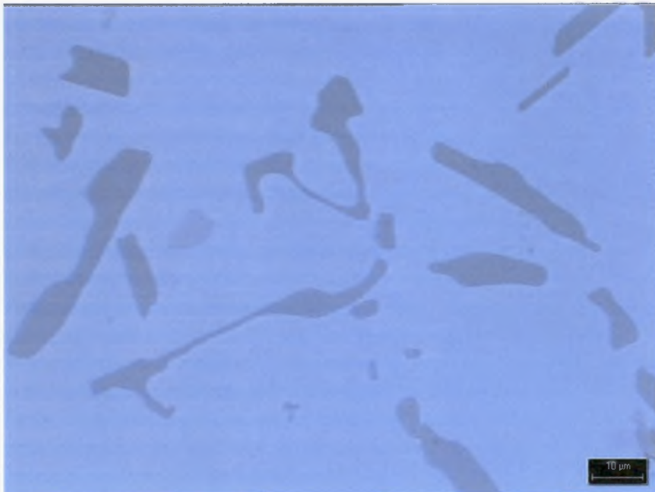
Εικόνα 5.3.2(β) Μικροδομή κράματος αλουμινίου AlSi10Mg [x1000]
