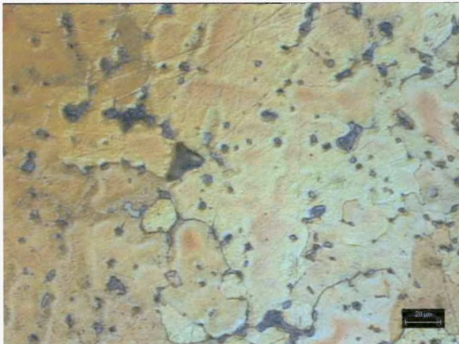
Εικόνα 5.3.6(β) Μικροδομή κράματος χαλκού CuSn7ZnPb [x500]
