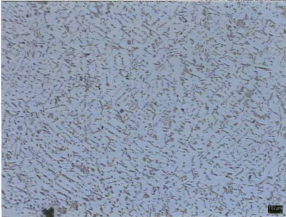
Εικόνα 5.3.2(α) Μικροδομή κράματος αλουμινίου AlSi10Mg [x50]
