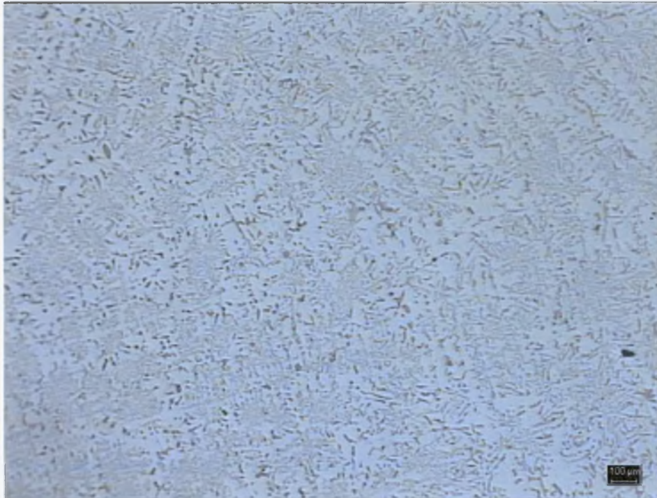
Εικόνα 5.3.3(α) Μικροδομή κράματος αλουμινίου AlSi12 [x50]
