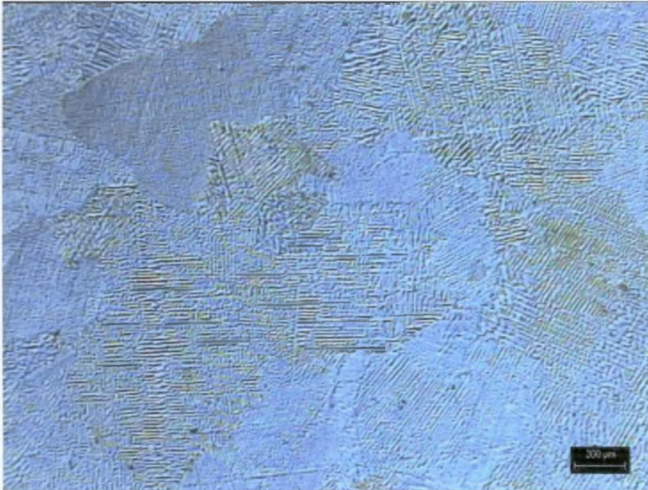
Εικόνα 5.3.9(α) Μικροδομή κράματος χαλκού CuAl9Ni [x50]
