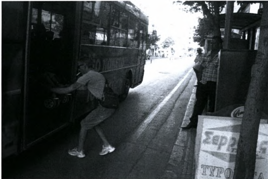
Φ1.11. Ο οδηγός του λεωφορείου σταματάει σε απόσταση από το ρείθρο – οι επιβάτες εισέρχονται στην οδό για να επιβιβαστούν
