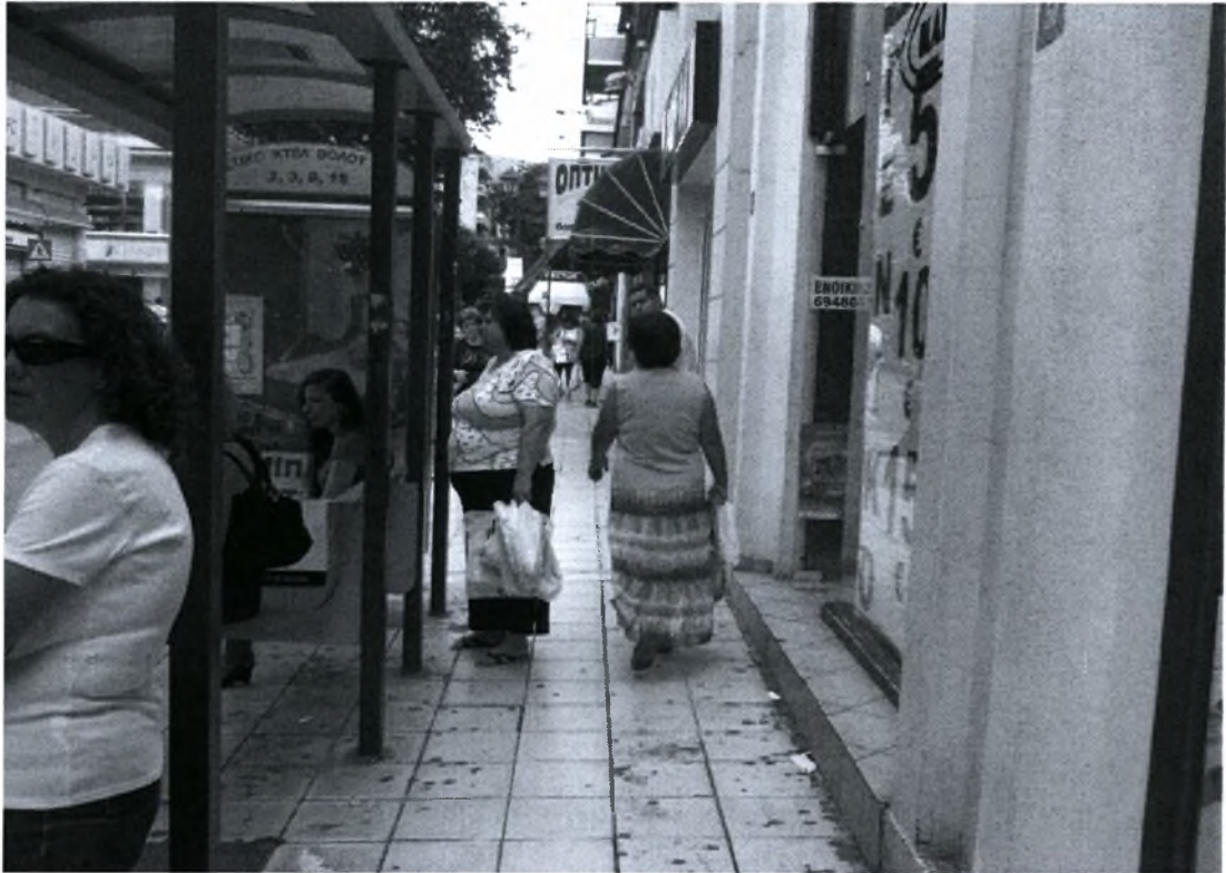
Φ4.3. Ανεπάρκεια πεζοδρομίων στη διατομή της στάσης (1.20 μ) για την εξυπηρέτηση του υψηλού φόρτου των διερχόμενων πεζών
