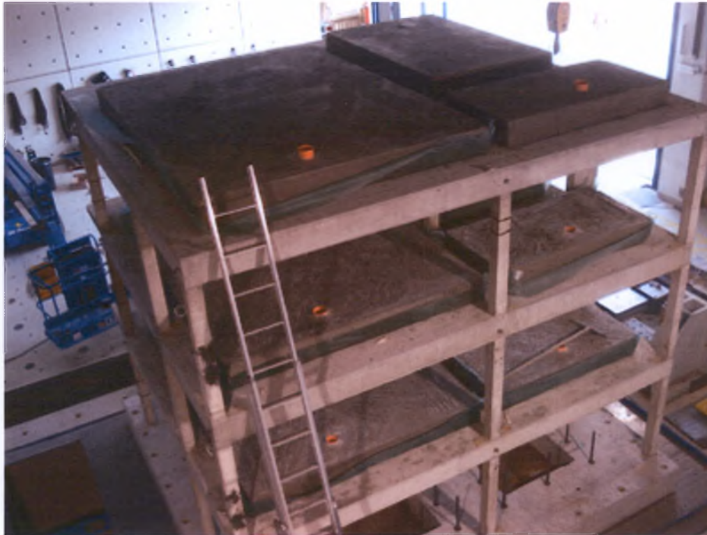
Εικόνα 2-2 Πρόσθετη μάζα για την προσομοίωση μόνιμων και κινητών φορτίων
