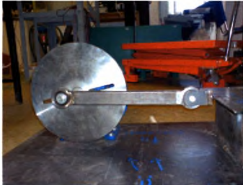
Εικ.[3.33]: Έκκεντρο, Μπιέλα – Σύνδεση με Πλάκα Ταλάντωσης
