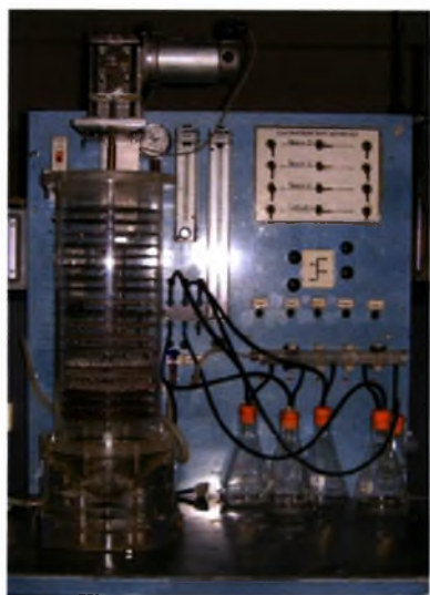
Εικ.[2.8]: Μηχανισμός Επίπλευσης με μέγεθος Πλέγματος 8mm και διαστήματος 18mm
