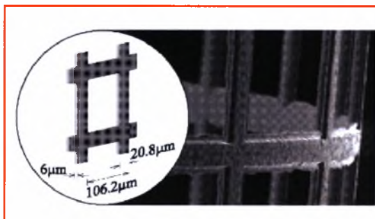
Εικ.[2.9]: Εικόνα από ηλεκτρονικό μικροσκόπιο πλέγματος από το οποίο διέρχεται ήλιο (He II) χαμηλής θερμοκρασίας.
