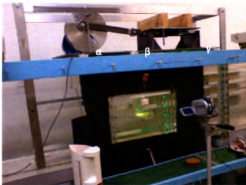
Εικ.[3.35]: Στήριξη Ταλαντωτή, σημεία α, β, γ
