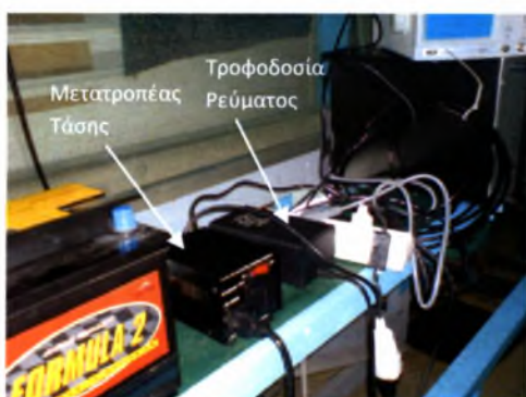
Εικ.[3.63] Τροφοδοτικό και Μετατροπέας Τάσης από 240V@50Hz στα 120V@60Hz
