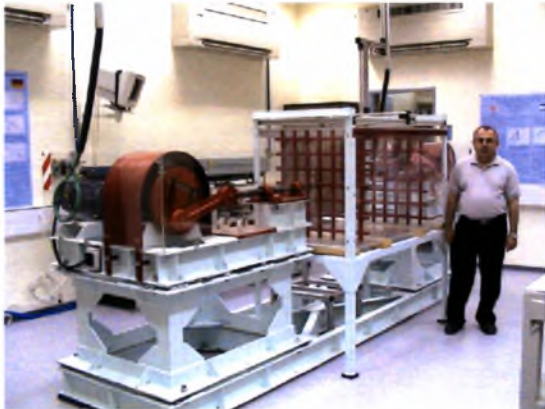
Εικ.[2.6]: Μηχανισμός Παραγωγής Τύρβης με θάλαμο 75x75x150cm 3
