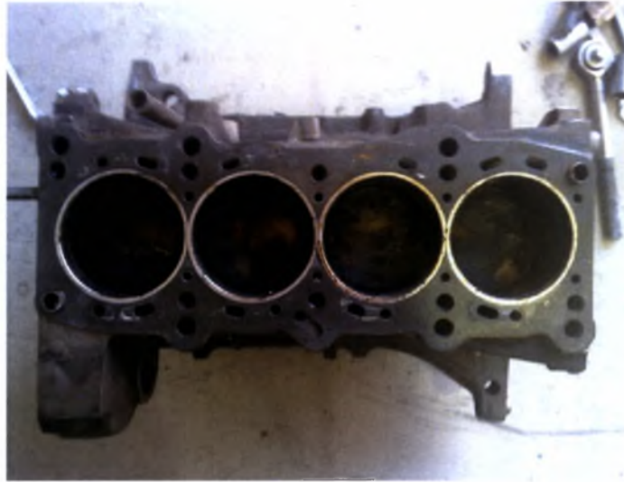
Σχήμα Π2.1: Κινητήρας fiat όπως ανοίχθηκε πριν τον καθαρισμό του (με φλάντζα κεφαλής).
