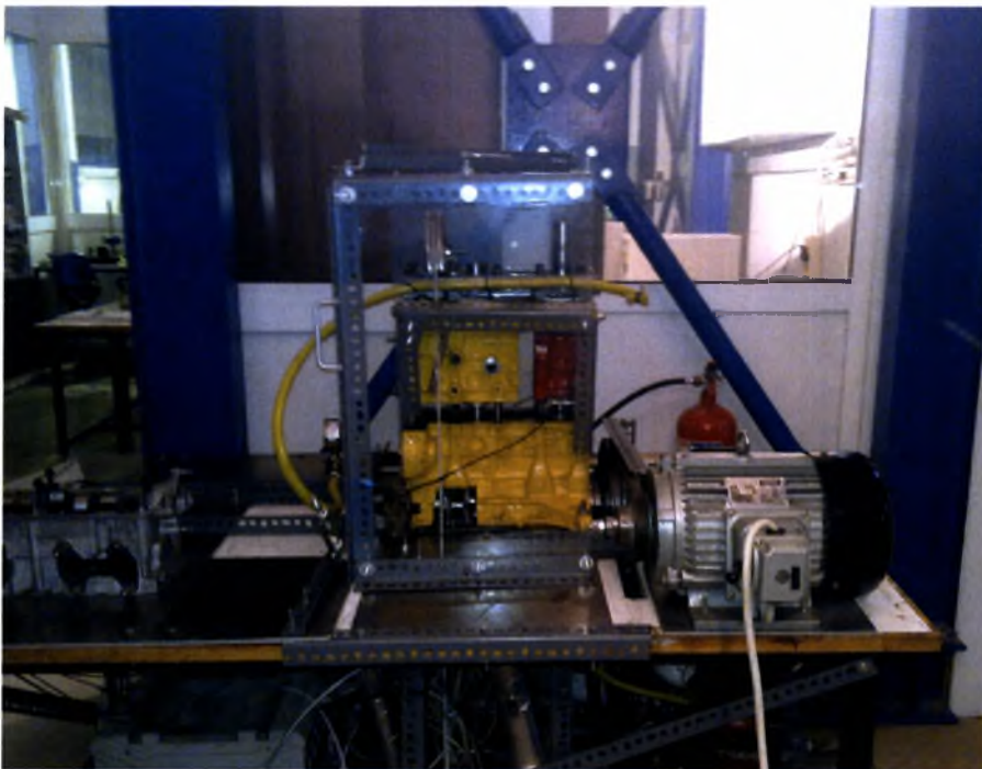
Σχήμα 2.11: Συναρμολογημένο σύνολο προσομοιωτή δεύτερης γενιάς Fiat, διακρίνονται τα σώματα των κινητήρων και ο πλωτός κύλινδρος και ο ηλεκτροκινητήρας.
