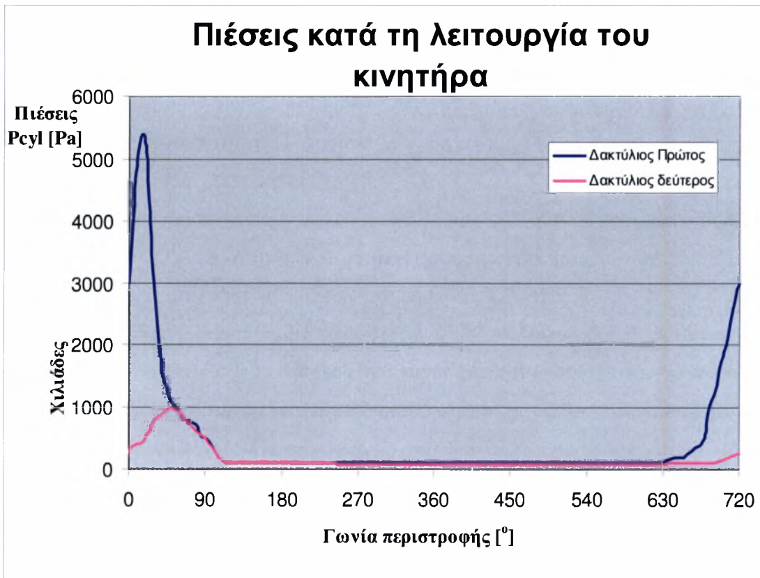
Σχήμα 1.17: Μεταβολή της πίεσης στο θάλαμο καύσης και στον χώρο μεταξύ 1 ου και 2 ου δακτυλίου (blow by) για κινητήρα Renault 551 σε πλήρες φορτίο.
