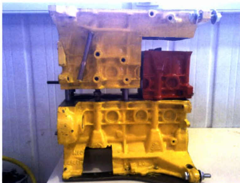
Σχήμα 2.15: Αντικριστά τοποθετημένα σώματα κινητήρων του προσομοιωτή 2 ης γενιάς. Το κίτρινο πακτώνεται, ενώ το κόκκινο είναι το «πλωτό» και χρησιμοποιείται για τη μέτρηση δυνάμεων.
