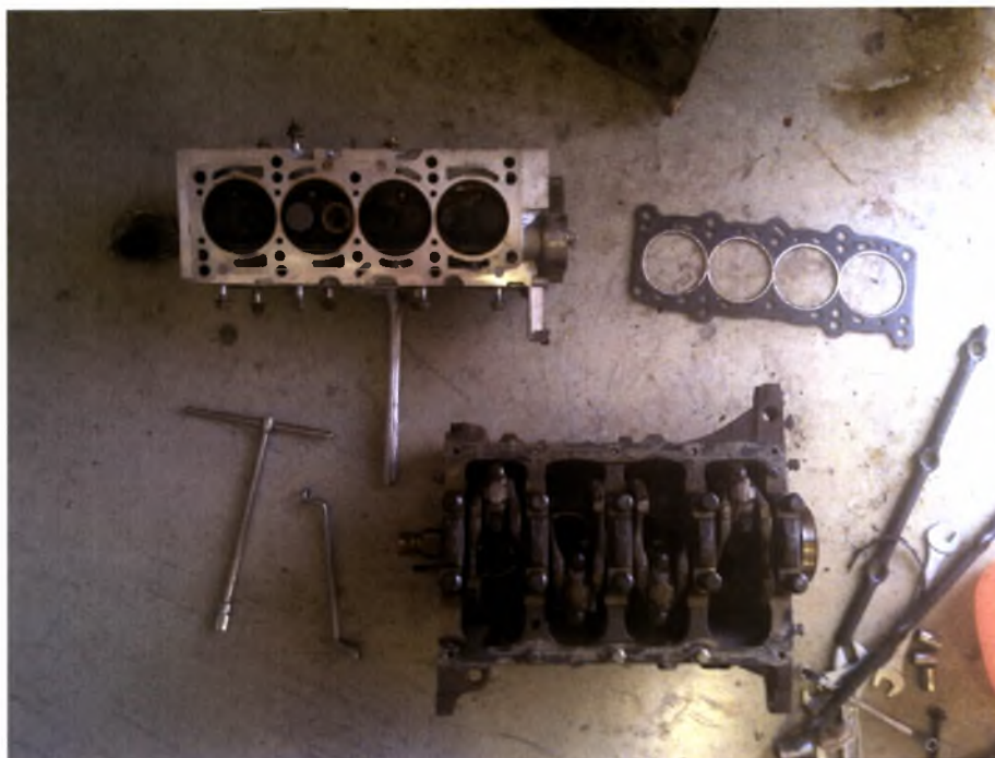
Σχήμα Π2.6: Κυλινδροκεφαλή, φλάντζα κεφαλής και σώμα κινητήρα .
