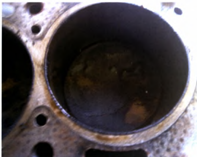
Σχήμα Π2.2: Κατάλοιπα καύσης του καυσίμου μετά από χρόνια λειτουργία του κινητήρα.
