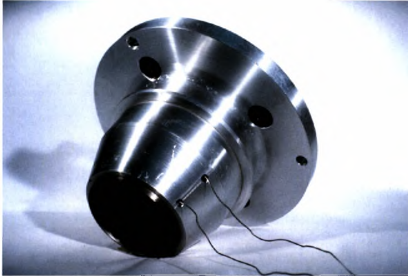
Σχήμα 2.14: Ο «πλωτός» κύλινδρος του προσομοιωτή πρώτης γενιάς αυτός προσαρμόζεται στη μετρητική συστοιχία.
