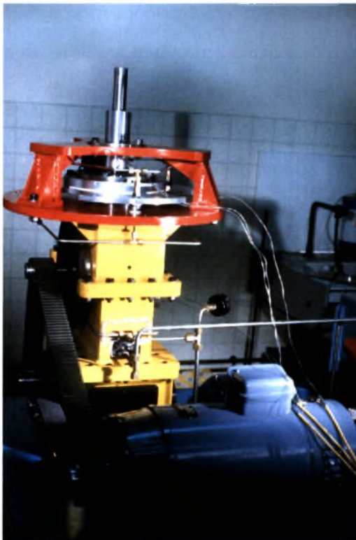
Σχήμα 2.9: Συναρμολογημένο σύνολο μονοκύλινδρου προσομοιωτή πρώτης γενιάς (Renault), διακρίνονται το σώμα του κινητήρα, η μετρητική συστοιχία-διάταξη, ο ηλεκτροκινητήρας που κινεί το σύνολο και ο οδοντωτός μάντας.
