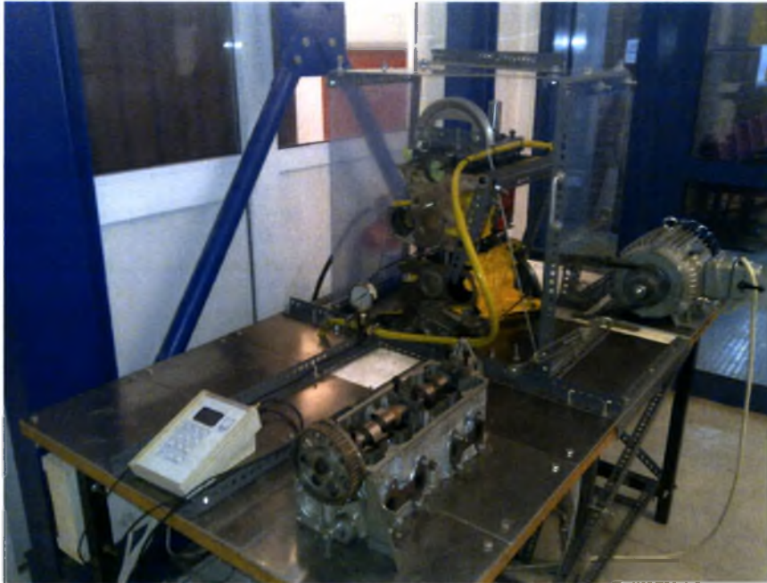
Σχήμα 2.8: Συναρμολογημένο σύνολο μονοκύλινδρου προσομοιωτή δεύτερης γενιάς (Fiat), διακρίνονται το σώμα του κινητήρα, η μετρητική συστοιχία-διάταξη και ο ηλεκτροκινητήρας που κινεί το σύνολο.
