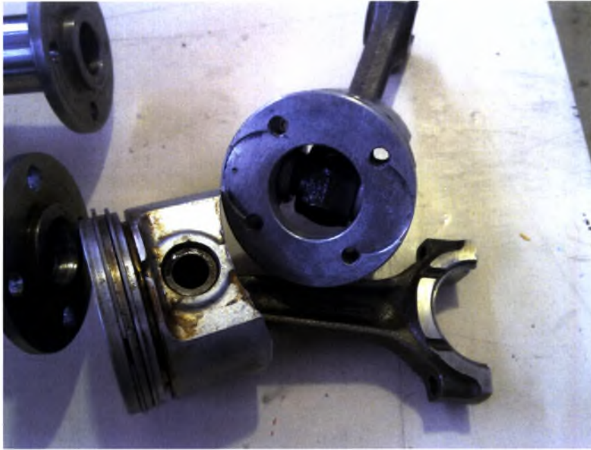
Σχήμα 2.22: Κατεργασμένα έμβολα του κάτω κινητήρα, πάνω στα οποία τοποθετούνται οι οδηγόι εμβόλων. Η σύνδεση γίνεται με διάνοιξη «φωλιάς» στο πάνω μέρος του εμβόλου και συμμετρικά(ανά 90°) ανοιγμένες σπές με σπείρωμα M5.
