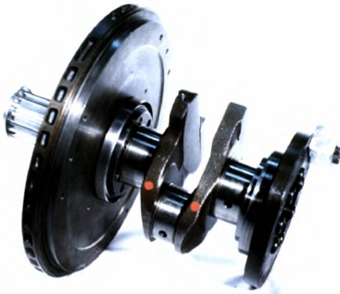
Σχήμα 2.24: Στροφαλοφόρος μονοκύλινδρου προσομοιωτή πρώτης γενιάς, με ειδική κατεργασία για μετάδοση κίνησης από οδοντωτό μάντα.
