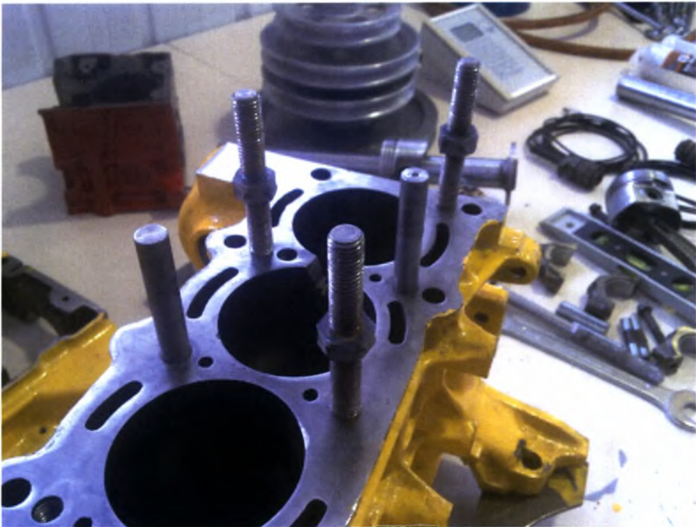
Σχήμα 2.26: Ειδικά τεμάχια με αντίστροφα σπειρώματα (M12) για τη σύνδεση των δυο αντικριστών σωμάτων των μηχανών και ειδικού μήκους πείρους (Φ12) για στιβαρή και αυστηρά παράλληλη τοποθέτηση των κινητήρων.
