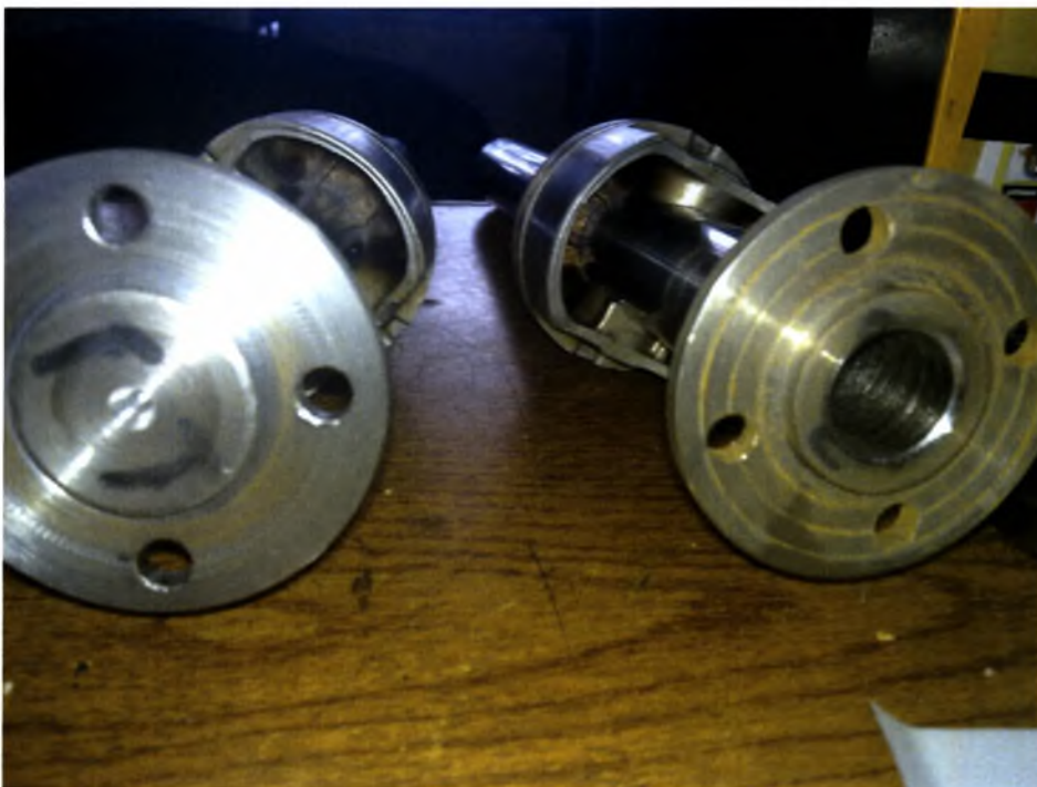
Σχήμα 2.23: Κάτω μέρος οδηγών εμβόλων με ειδική διάταξη για να εφαρμόζουν με ασφάλεια επάνω στα έμβολα και επιπρόσθετη αφαίρεση υλικού από το εσωτερικό τους.
