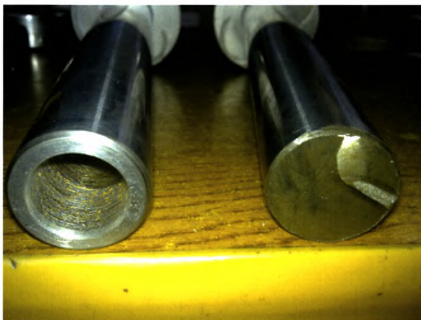
Σχήμα 2.21: Επάνω μέρος οδηγών εμβόλων. Το αριστερό έχει υποστεί κατεργασία αφαίρεσης υλικού στο εσωτερικό του στον τόρνο για μείωση του βάρους του.
