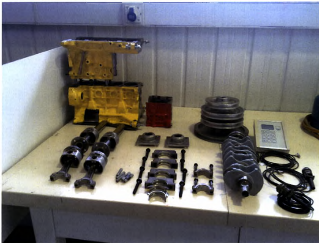
Σχήμα 2.16: Πλήρες αποσυναρμολογημένος ο προσομοιωτής δεύτερης γενιάς η μετρητική συστοιχία και οι τροχαλίες μετάδοσης της κίνησης.
