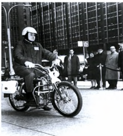
Σχήμα 2.27. Ο εφευρέτης Karl Kordesch της Union Carbide οδηγεί την πρώτη μοτοσικλέτα που τροφοδοτείται από αλκαλικές κυψελίδες [17].
