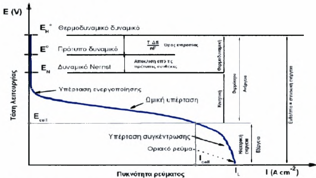
Σχήμα 2.7. Τυπική συμπεριφορά λειτουργίας κελιού καυσίμου [25].
