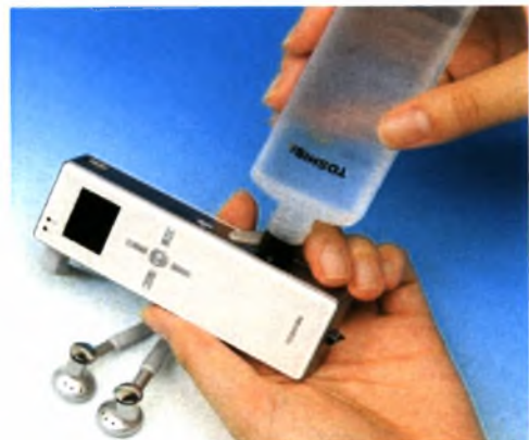
Σχήμα 2.35. Mp3 της Toshiba με άμεση τροφοδοσία μεθανόλης [33].
