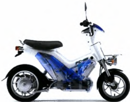
Σχήμα 2.32. Μοτοσικλέτα με εξ' ολοκλήρου τροφοδοσία μεθανόλης κατασκευασμένο από την Yamaha [30].
