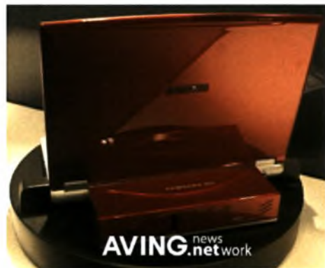
Σχήμα 2.33. Φορητός υπολογιστής της Samsung με τροφοδοσία μεθανόλης [31].
