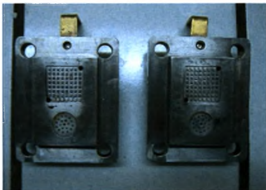
Σχήμα 4.4. (α) διπολικοί δίσκοι και κανάλια ροής ανόδου-καθόδου, (β) διάταξη ηλεκτροδίου / μεμβράνης / ηλεκτροδίου (MEA).
