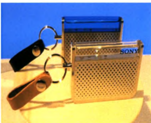
Σχήμα 2.34. Οι τελευταίες κυψέλες της Sony με άμεση τροφοδοσία μεθανόλης [32].
