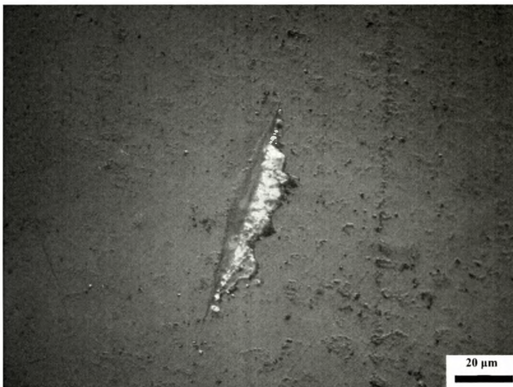
Σχήμα 4.6. Φωτογραφία (1000x) από το δεύτερο ίχνος στο σμάλτο (1 ο profile)
