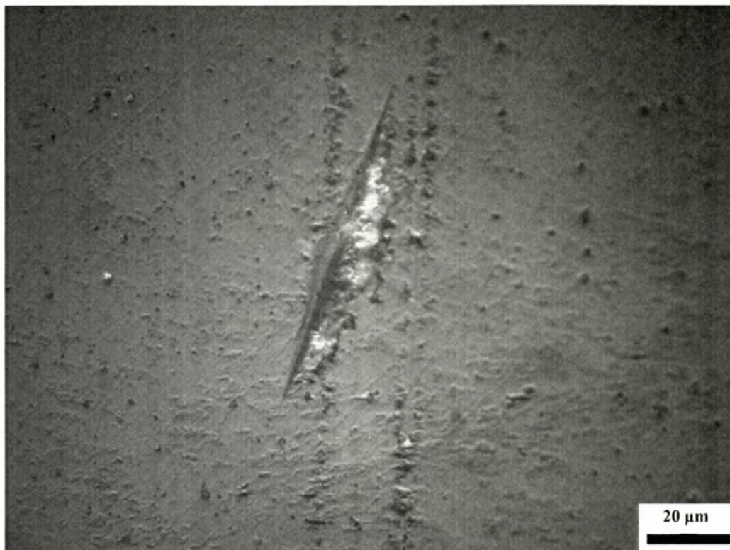
Σχήμα 4.9. Φωτογραφία (1000x) από το πέμπτο ίχνος στο σμάλτο (1 ο profile)
