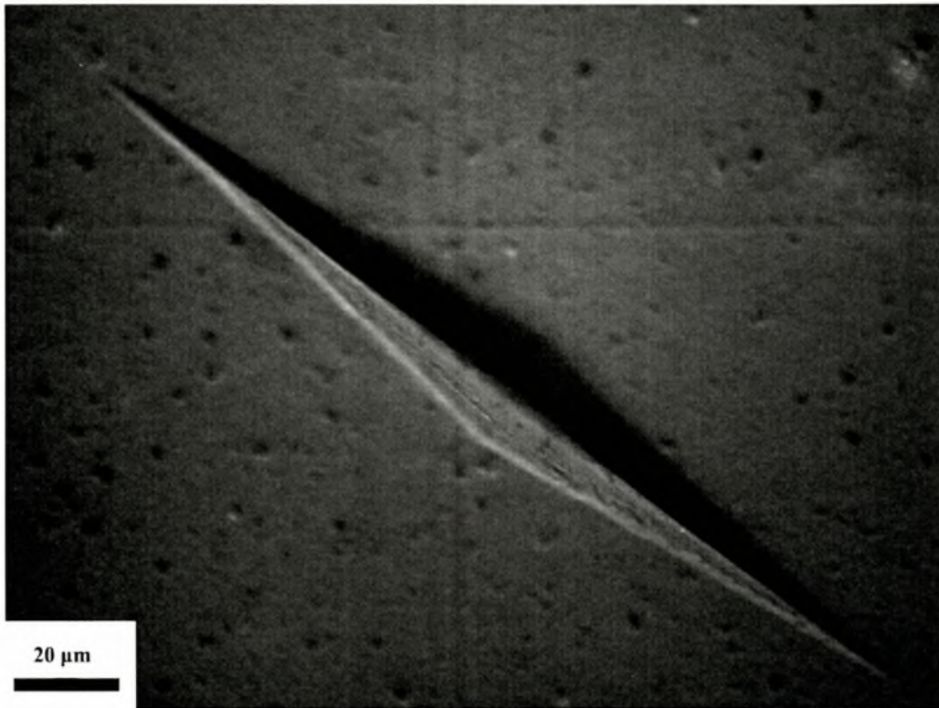
Σχήμα 4.19. Φωτογραφία (1000x) από το έβδομο ίχνος στην οδοντίνη (1 ο profile)
