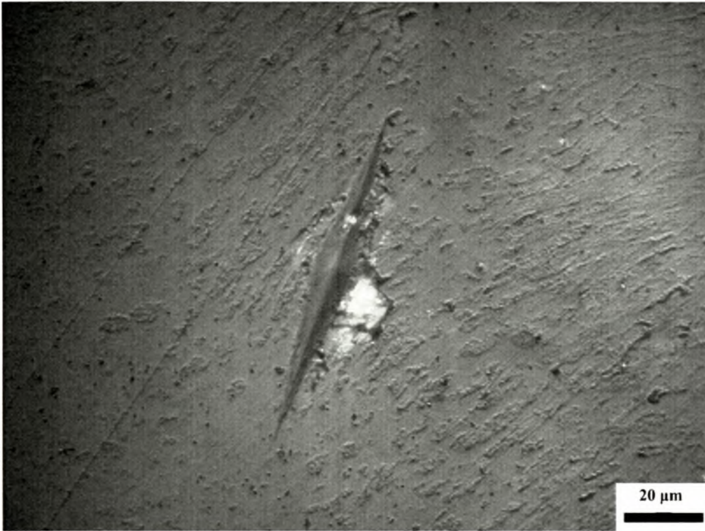
Σχήμα 4.11. Φωτογραφία (1000x) από το έβδομο ίχνος στο σμάλτο (1 ο profile)
