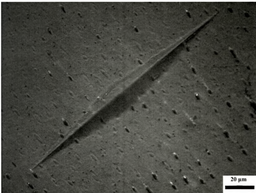
Σχήμα 4.22. Φωτογραφία (1000x) από το δέκατο ίχνος στην οδοντίνη (1 ο profile)
