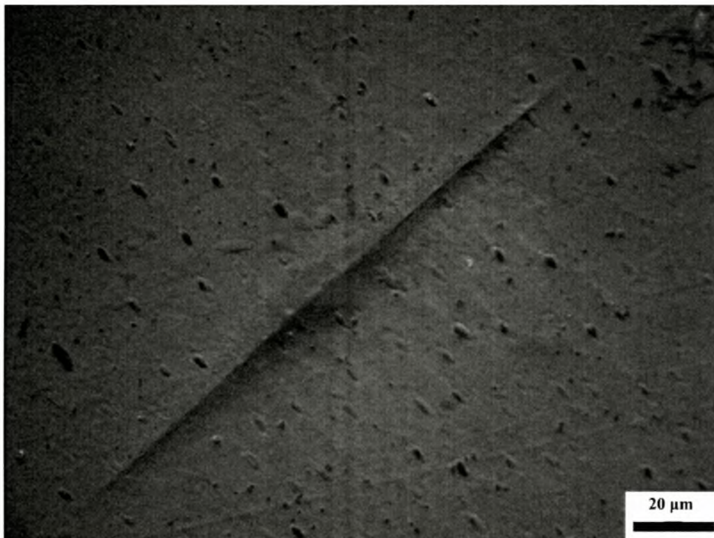
Σχήμα 4.20. Φωτογραφία (1000x) από το όγδοο ίχνος στην οδοντίνη (1 ο profile)
