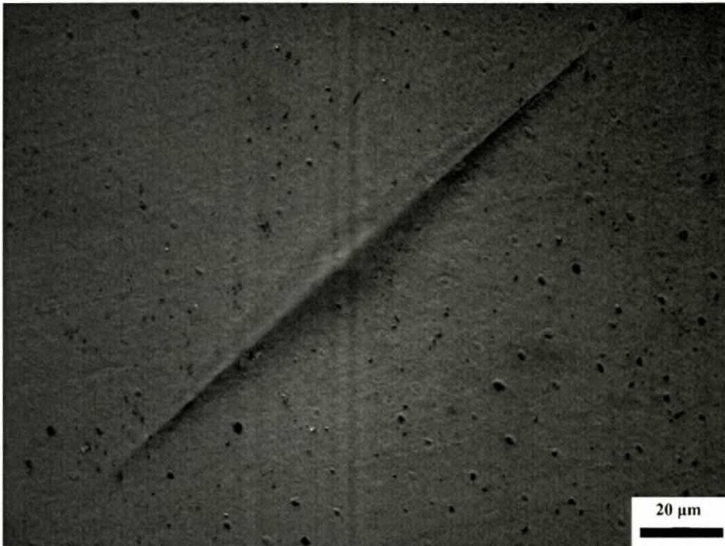
Σχήμα 4.17. Φωτογραφία (1000x) από το πέμπτο ίχνος στην οδοντίνη (1 ο profile)
