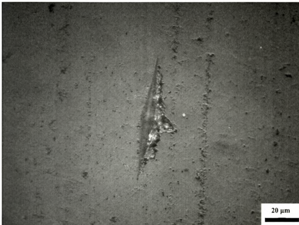
Σχήμα 4.5. Φωτογραφία (1000x) από το πρώτο ίχνος στο σμάλτο (1 ο profile)
