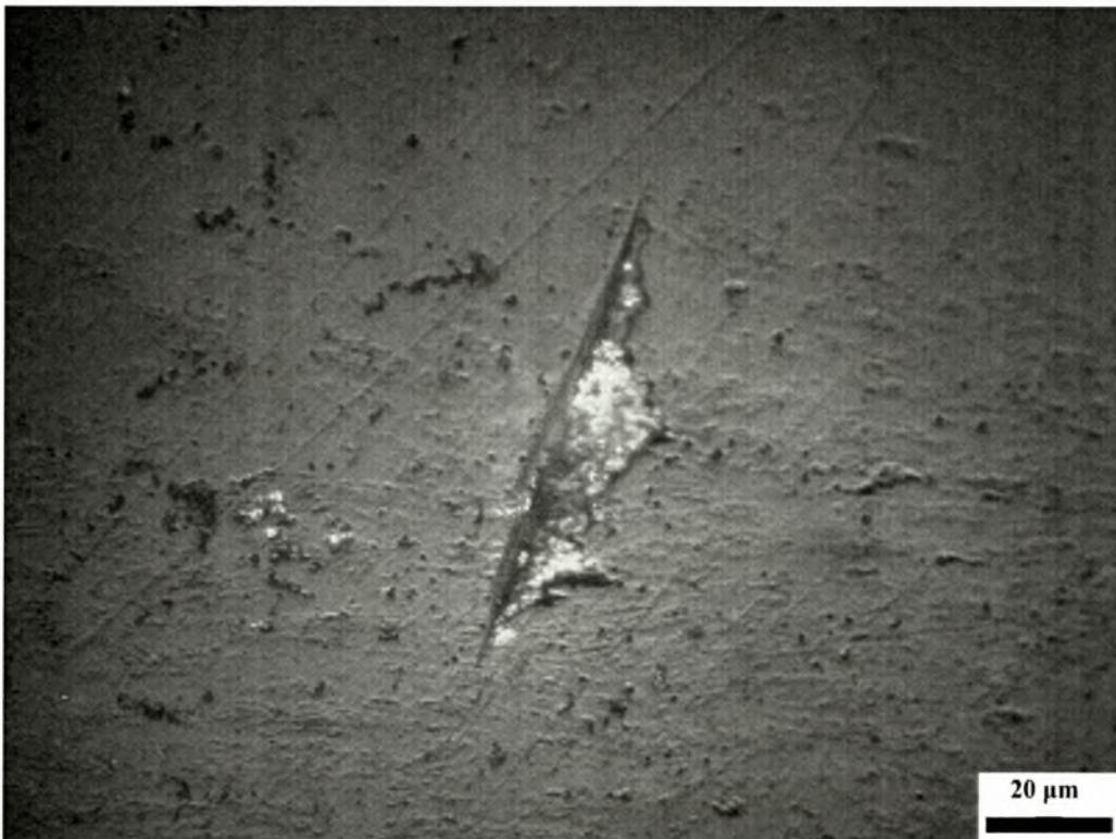
Σχήμα 4.8. Φωτογραφία (1000x) από το τέταρτο ίχνος στο σμάλτο (1 ο profile)
