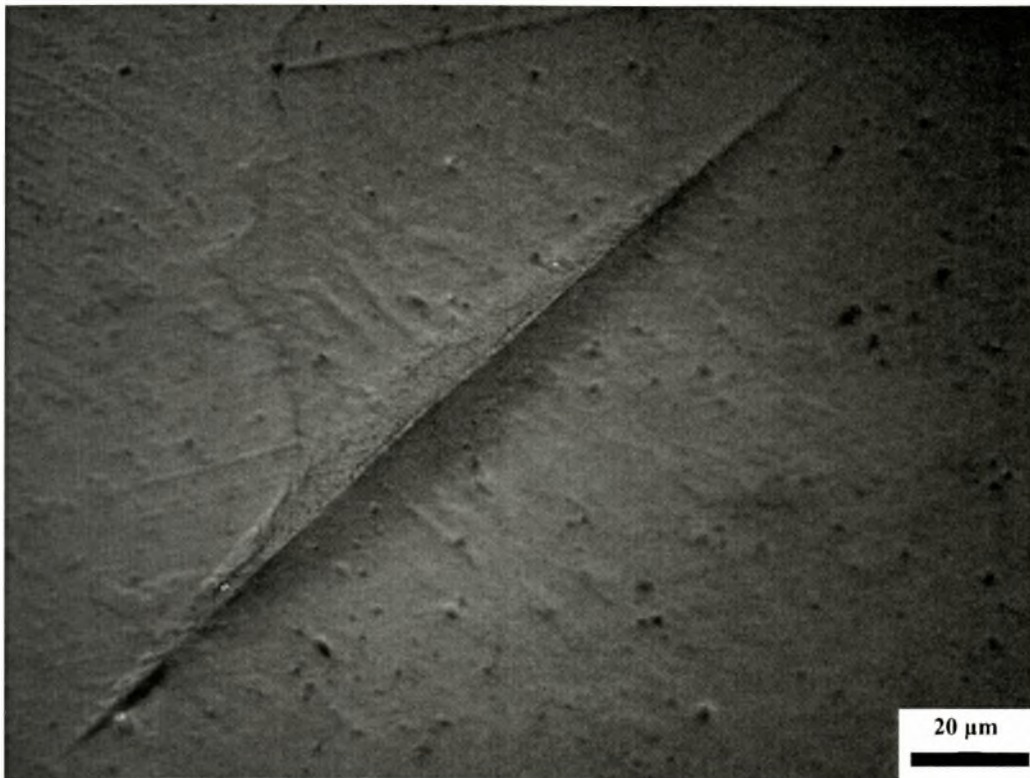
Σχήμα 4.13. Φωτογραφία (1000x) από το πρώτο ίχνος στην οδοντίνη (1 ο profile)
