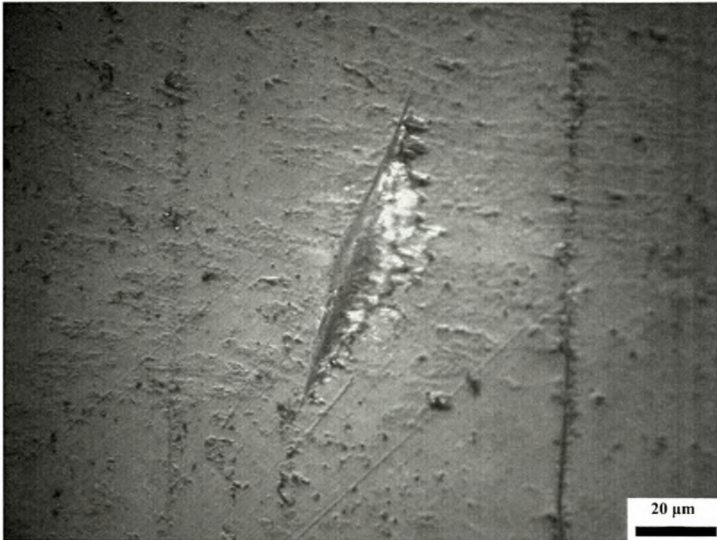
Σχήμα 4.7. Φωτογραφία (1000x) από το τρίτο ίχνος στο σμάλτο (1 ο profile)
