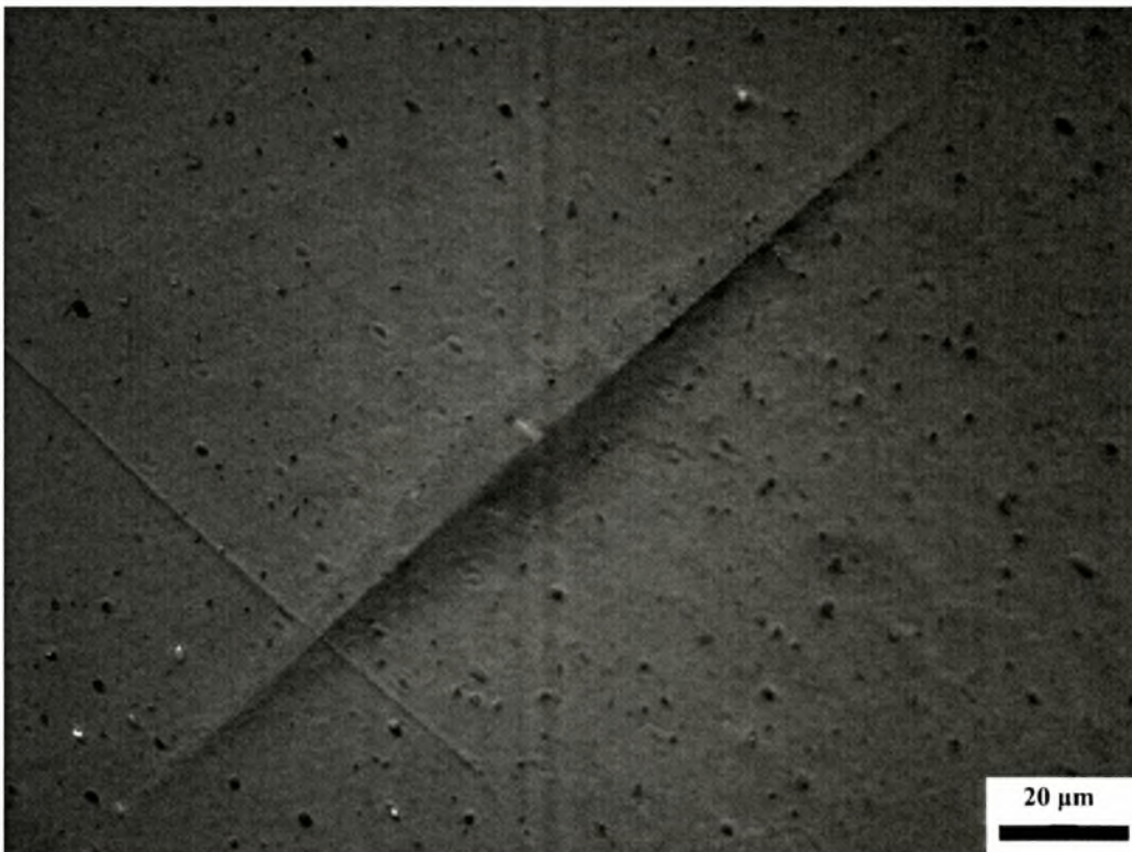
Σχήμα 4.18. Φωτογραφία (1000x) από το έκτο ίχνος στην οδοντίνη (1 ο profile)
