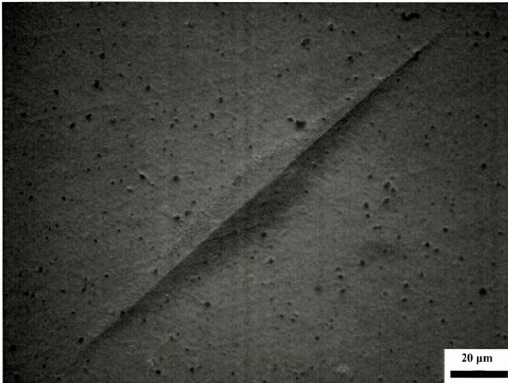
Σχήμα 4.15. Φωτογραφία (1000x) από το τρίτο ίχνος στην οδοντίνη (1 ο profile)
