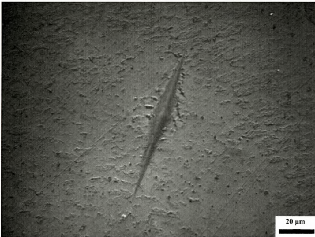
Σχήμα 4.12. Φωτογραφία (1000x) από το όγδοο ίχνος στο σμάλτο (1 ο profile)
