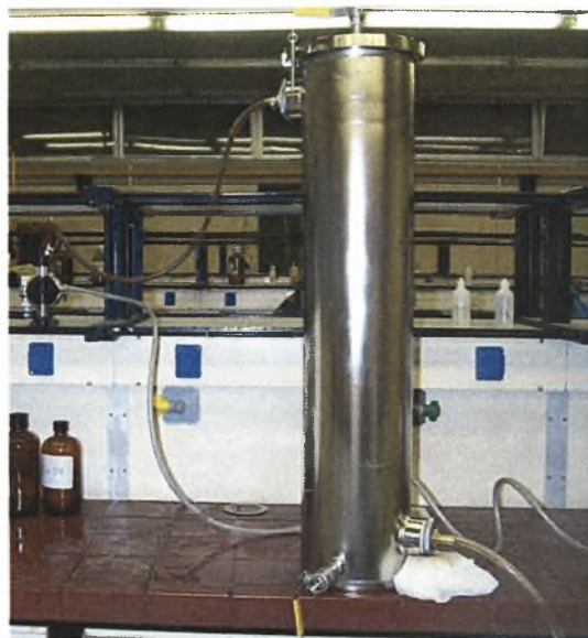
Εικόνα 4. Περιέκτης από ανοξείδωτο ασάλι με σακόφιλτρο που διαθέτει πόρους 25 \mu\text{m}
