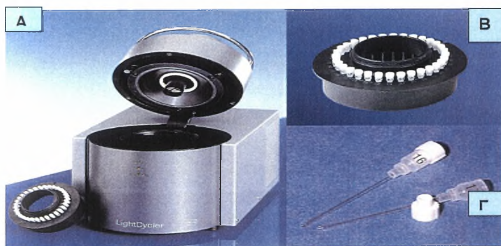
Εικόνα 2.14: Α. Μηχάνημα Light Cycler ((Roche). Β. Δίσκος τοποθέτησης τριχοειδών (carousel) Γ. Υάλινα τριχοειδή (Glass capillaries)
