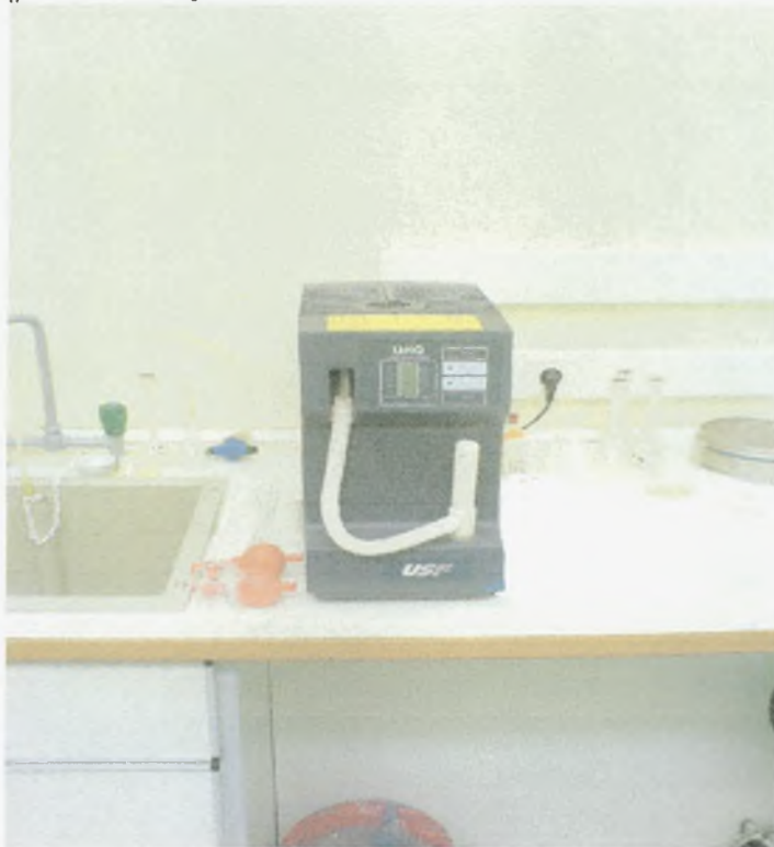
Εικόνα 2.8. Συσκευή παραγωγής ύδατος υψηλής καθαρότητας
