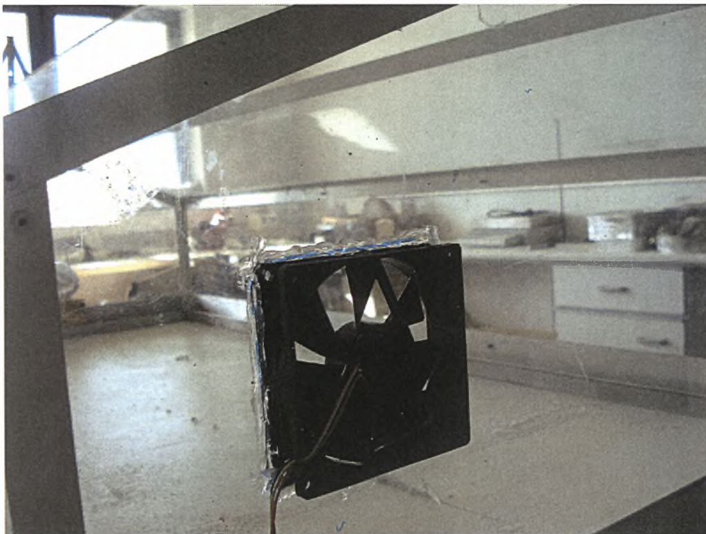
Φωτό 5: Σύστημα δυναμικού αερισμού (λεπτομέρεια)
