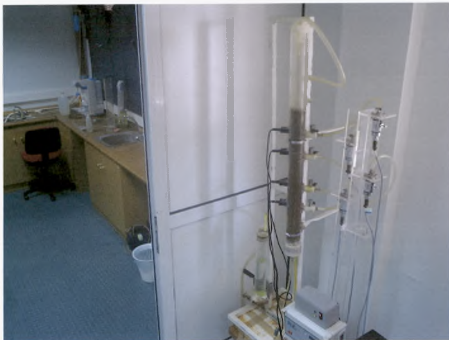
Εικόνα Β.5 Σύστημα κεραμικής κάψας – δεξαμενής νερού – εύκαμπτου σωλήνα όταν ήδη έχει συνδεθεί με την εδαφική στήλη και το μετατροπέα πίεσης.
