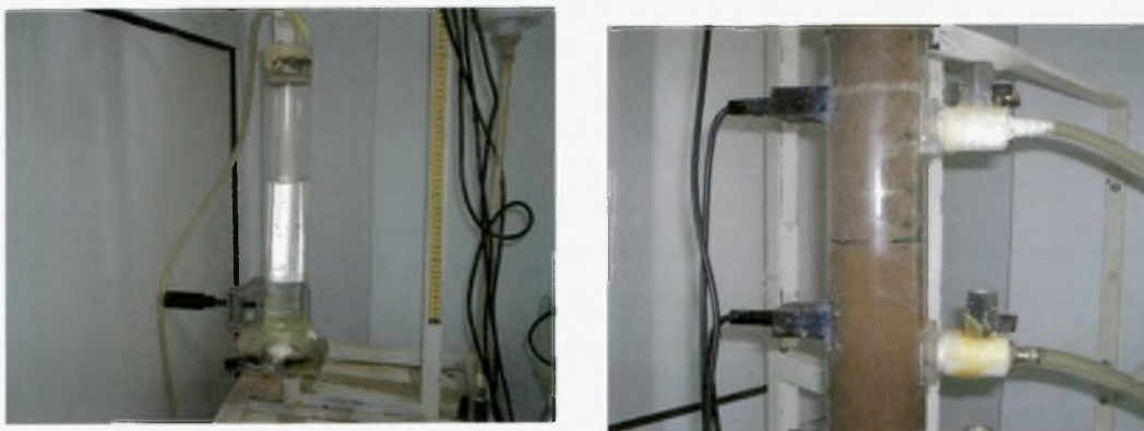
Εικόνα Β.2 Σύστημα κεραμικής κάψας – δεξαμενής νερού – εύκαμπτου σωλήνα όταν ήδη έχει συνδεθεί με την εδαφική στήλη
